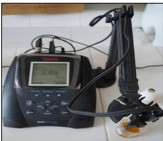
Foto11. Medición de pH del jarabe de yacón
