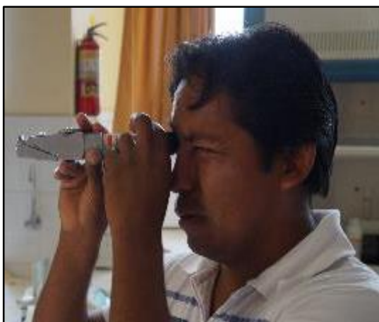
Foto 9. Control de los grados Brix del pre jarabe
