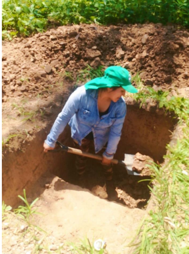
Foto N° 3. Realización de calicatas
