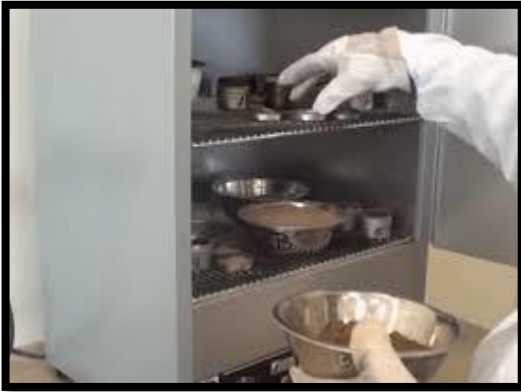
Ensayo de humedad
