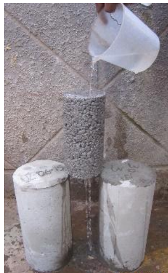
Ilustración 6. filtración de agua en el concreto permeable
