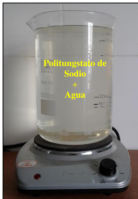
Figura 3.24.- (Líquido pesado + Agua) reposando en la cocina eléctrica para ser recuperada
