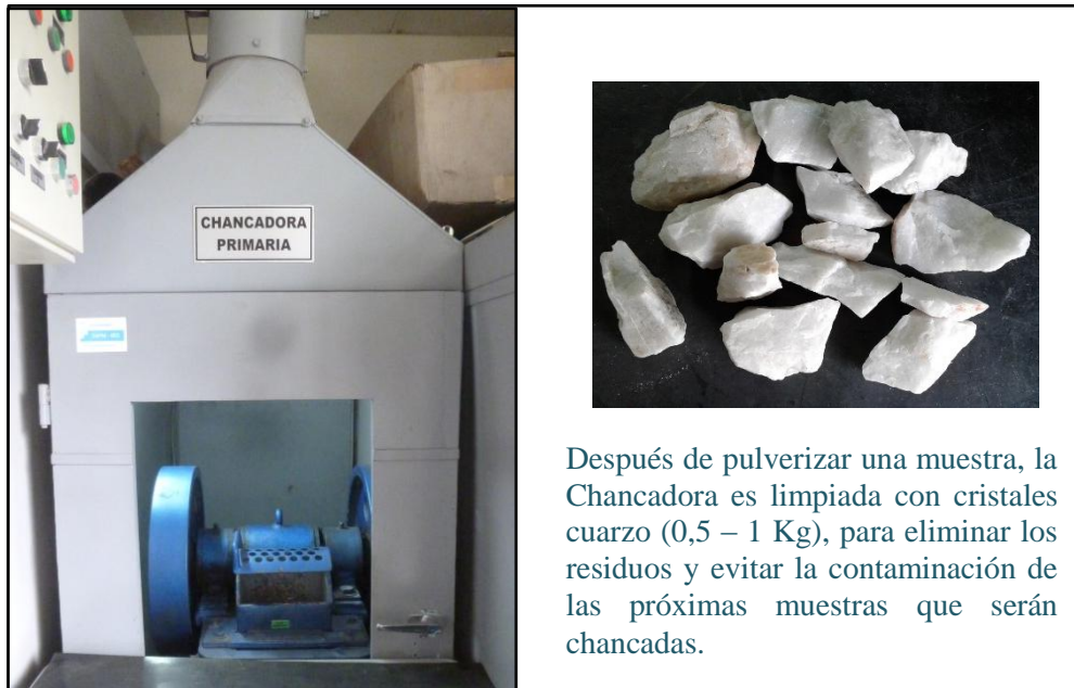
Figura 3.5.- Chancadora primaria (proceso).
