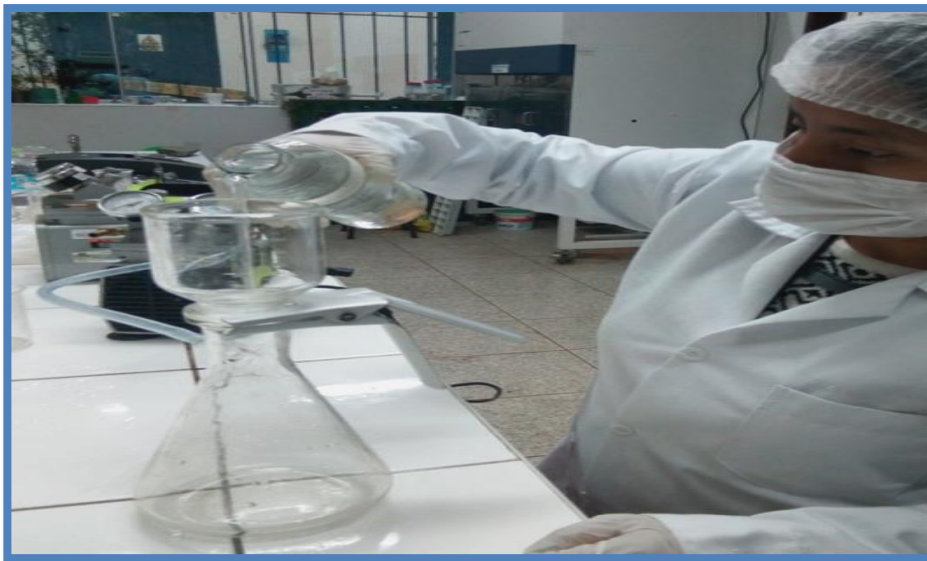
Imagen N° 01: Filtración de la muestra de agua a través del método de membrana
