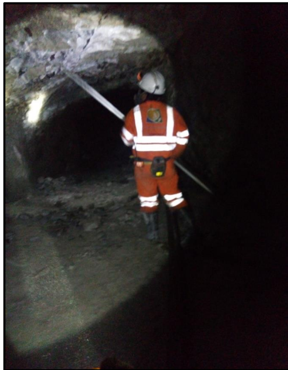
Fotografía 02. Desatado de rocas en el Sn. 175E Tj. 175
