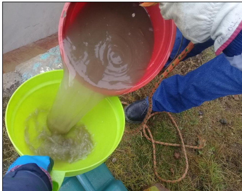
Detalle del llenado de efluentes domésticos a la galonera aproximadamente interdiario se recogía 15 litros.
