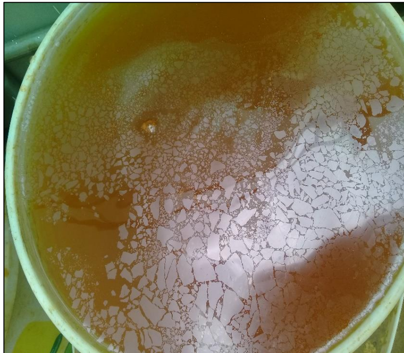
Detalle del color del lixiviado del barril y película grasosa bacteriana, producto del riego con efluentes domésticos y la reacción química de sulfato reducción.
