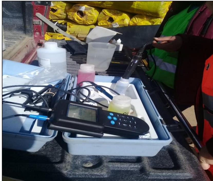
Detalle de calibración del multiparámetro utilizando buffers antes de la medición de parámetros de campo.
