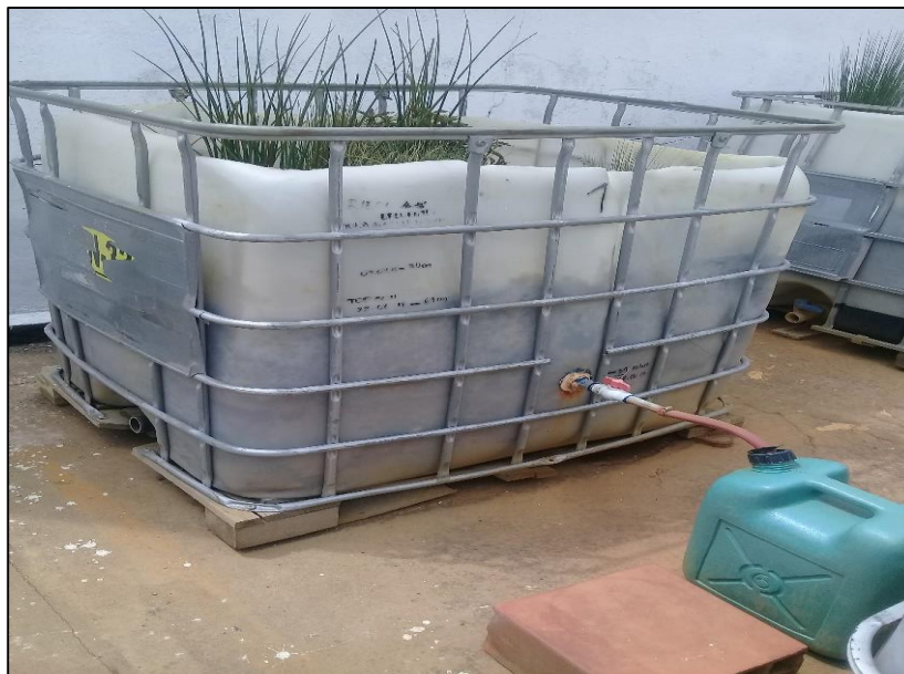
Sistema piloto de prueba de barril que contiene relave, cobertura biológica y sistema de drenaje de lixiviados.
