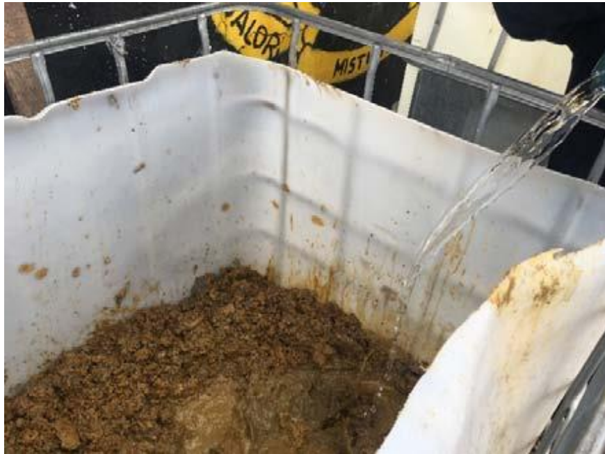
Ilustración 21. Saturación con agua del relave.
