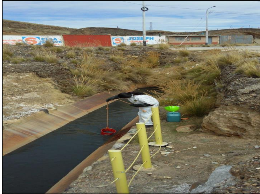
Detalle del recojo de efluente domésticos del margen izquierdo de la relavera Quiulacocha.
