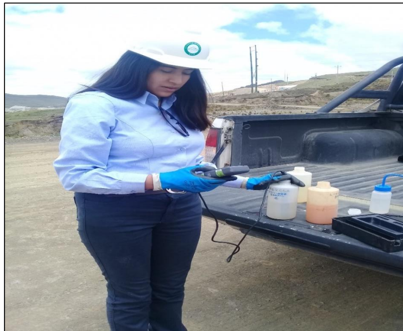
Medición de parámetros de campo del lixiviado del barril de prueba, utilizando multiparámetro.
