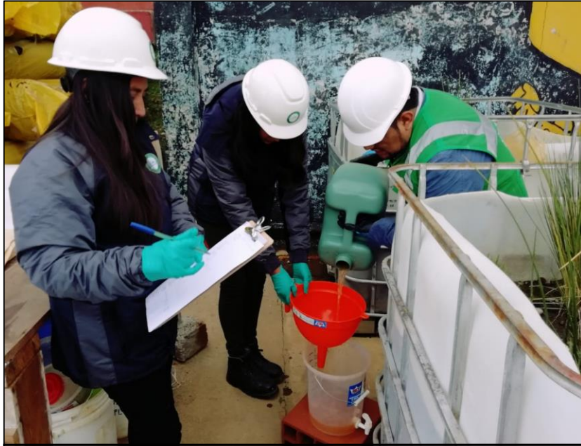
Detalle de la mezcla del lixiviado del barril a un balde recolector para la toma de muestra y medición de parámetros de campo.
