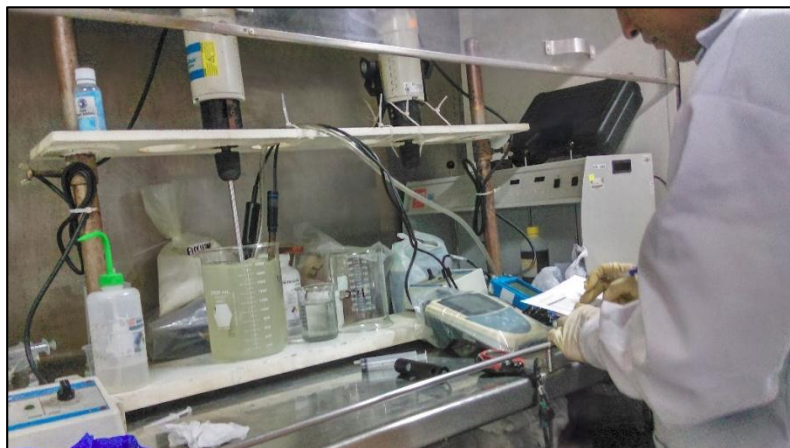
Fotografía N° 10: Control de parámetros en destrucción del cianuro.
