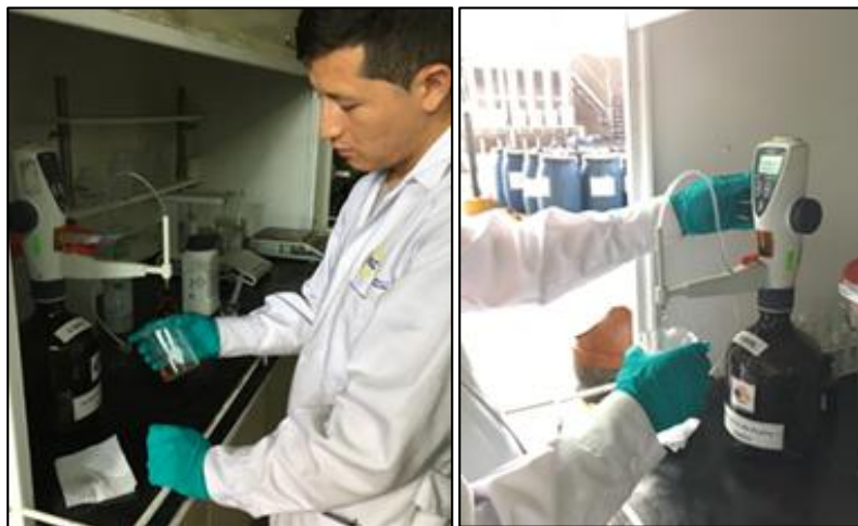
Fotografía N° 13: Medición de cianuro libre por titulación – In Situ.
