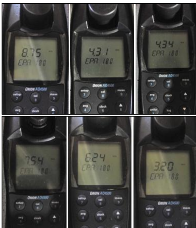
Figura N° 3.6: Medición de turbidez a 10 min. – Etapa de clarificación.
