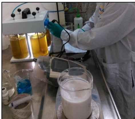
Fotografía N° 11: Control de parámetros en la etapa de precipitación.
