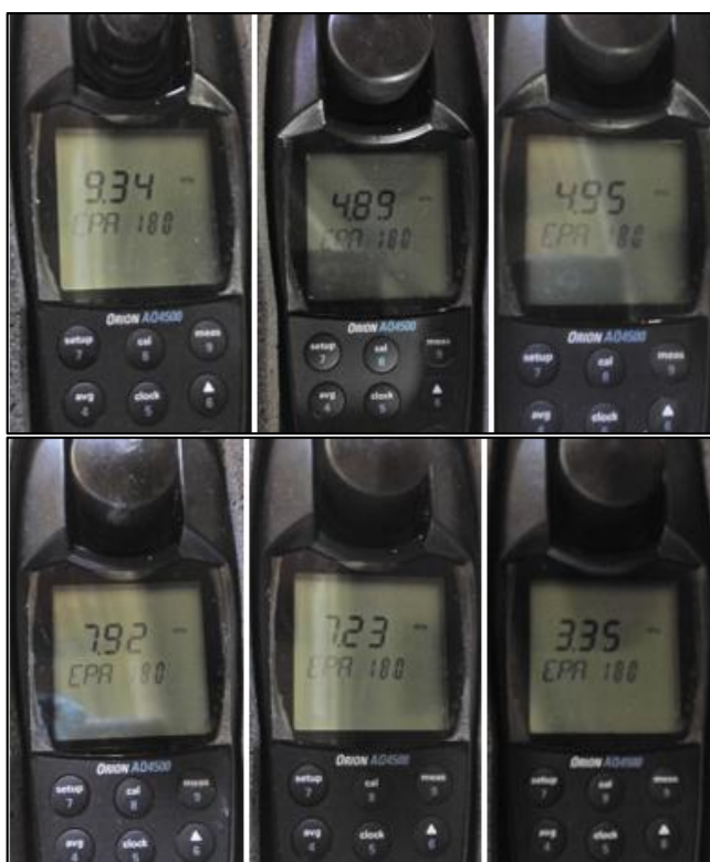
Figura N° 3.5: Medición de turbidez a 5 min. – Etapa de clarificación.
