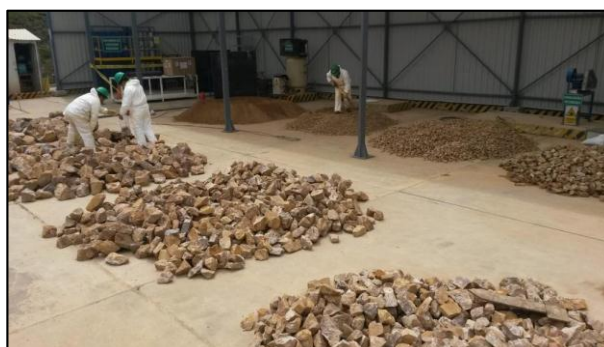
Figura N° 2.11: Análisis granulométrico para prueba en columnas.
