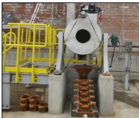
Figura N° 2.7: Hornos de fundición basculante – La Arena S.A.
