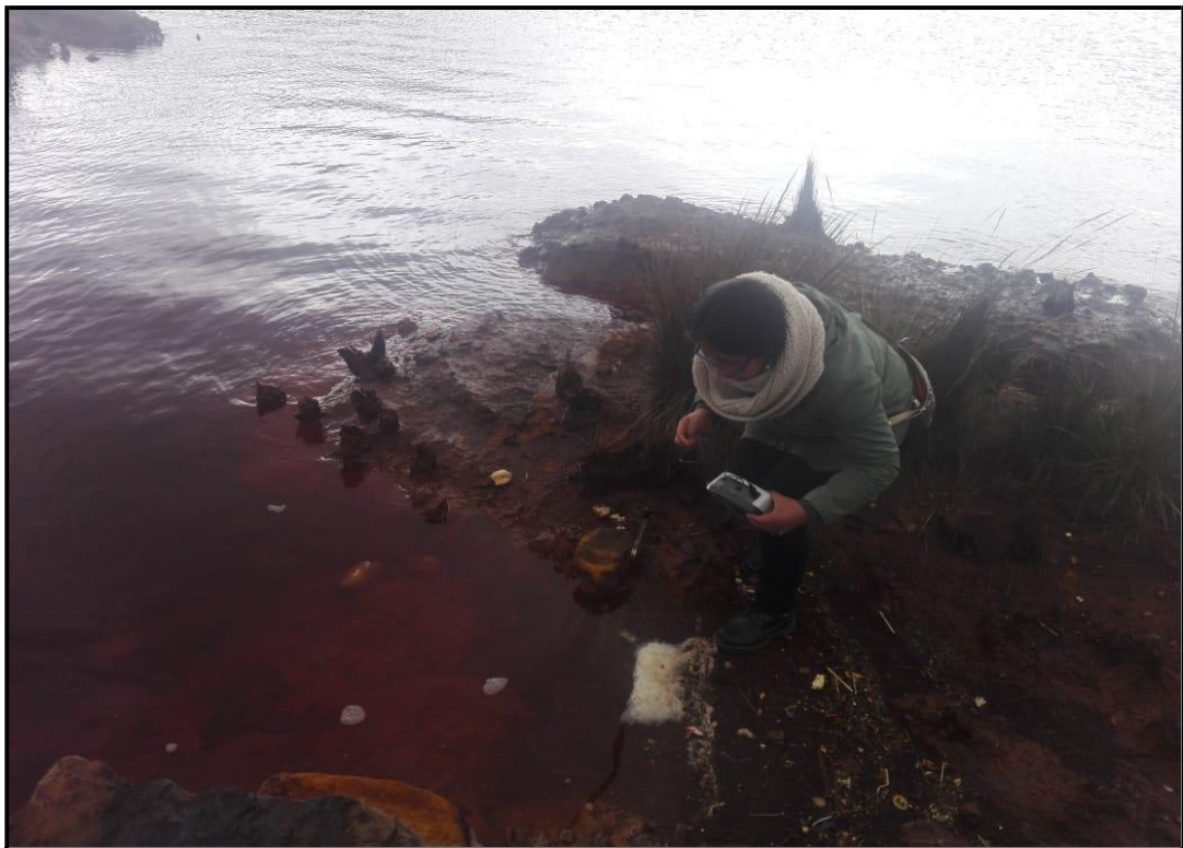
Fotografía N° 02: PASIVO AMBIENTAL DE RELAVES GENERANDO DRENAJE ACIDO
