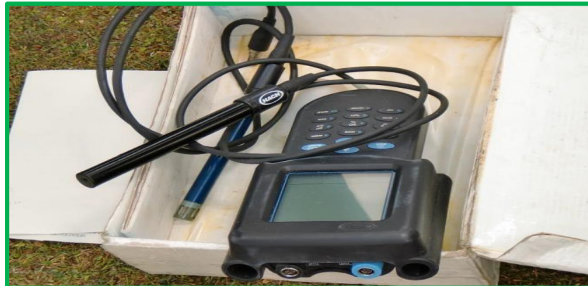
Fig 15 Equipo Hach para el análisis de agua in situ
