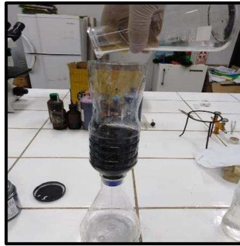
Foto 7, 8, 9 y 10: Aplicación del carbón activado de cáscara de coco en la muestra de agua a los tiempos designados 90 y 120 minutos, para luego ser analizados
