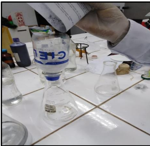
Foto 7, 8, 9 y 10: Aplicación del carbón activado de cáscara de coco en la muestra de agua a los tiempos designados 90 y 120 minutos, para luego ser analizados
