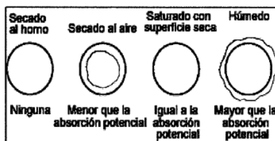
Ilustración 7. Agregados bajo condiciones de Humedad Fuente: Manual de prácticas del laboratorio de concreto.
