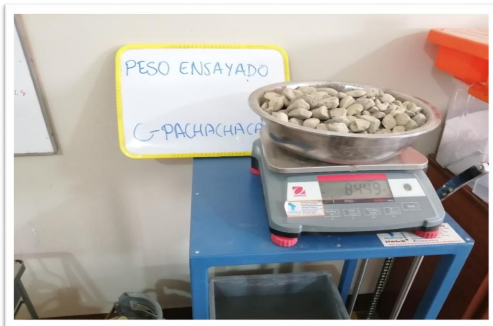
Figura F.43 Muestra del agregado grueso después del ensayo de Abrasión – cantera Pachachaca.
