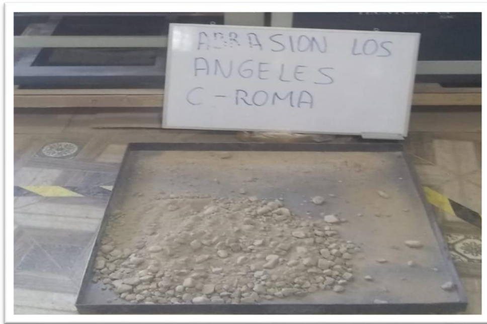
Figura F.38 Ensayo de Abrasión utilizando la máquina de los Angeles – cantera Roma.
