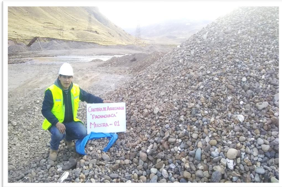
Figura F.5 Recojo de muestras de material zarandeado para realización de ensayos – cantera Pachachaca.
