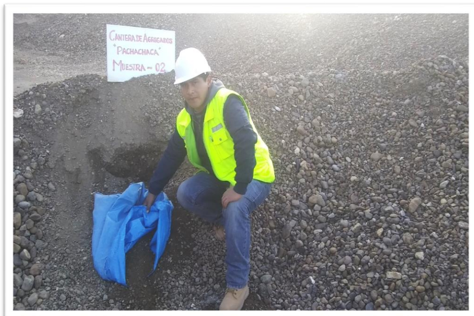
Figura F.6 Recojo de muestras de material zarandeado para realización de ensayos – cantera Pachachaca.
