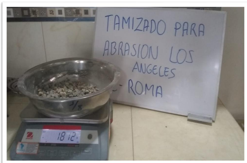
Figura F.37 Preparación de la muestra (agregado grueso) para la abrasión – cantera Roma.
