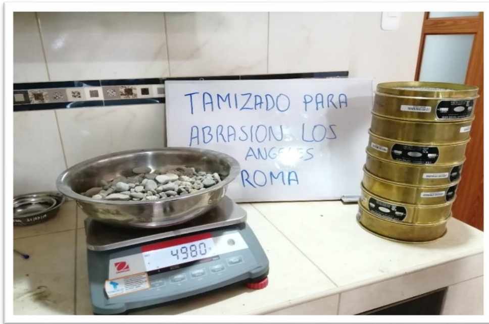
Figura F.36 Preparación de la muestra (agregado grueso) para la abrasión – cantera Roma.
