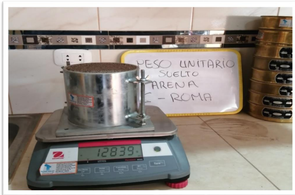
Figura F.20 Peso Unitario suelto del agregado fino – cantera Roma.
