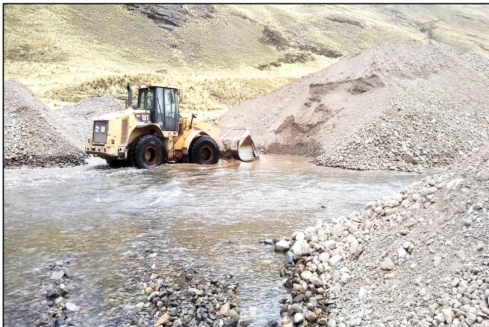
Figura 4-8 Proceso de extracción mecanizado (cargador frontal y zaranda) - cantera Pachachaca.
