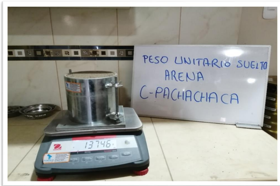
Figura F.24 Peso Unitario suelto del agregado fino – cantera Pachachaca.
