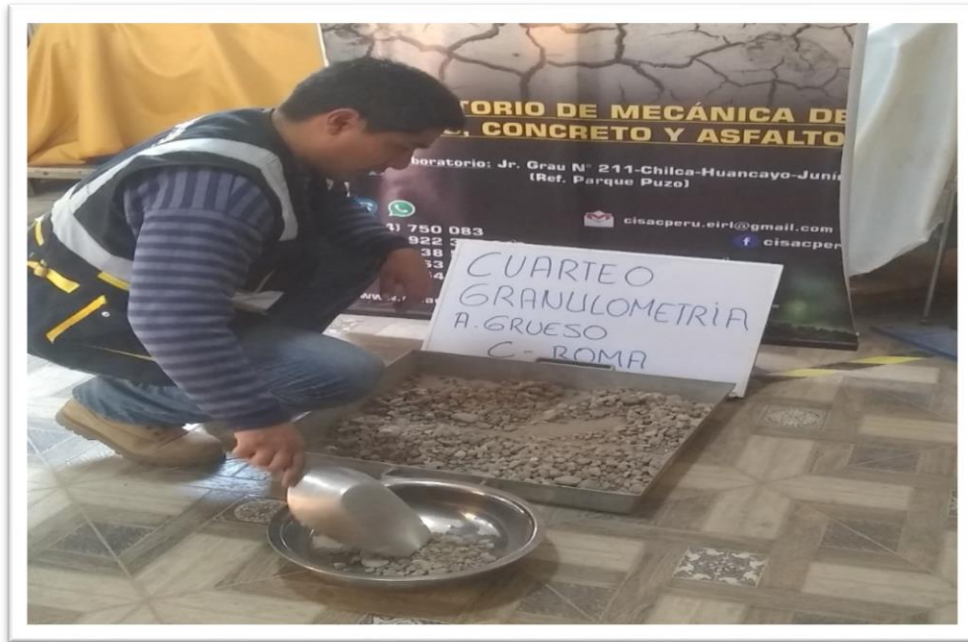
Figura F.30 Cuarteo para la granulometría del agregado grueso – cantera Roma.
