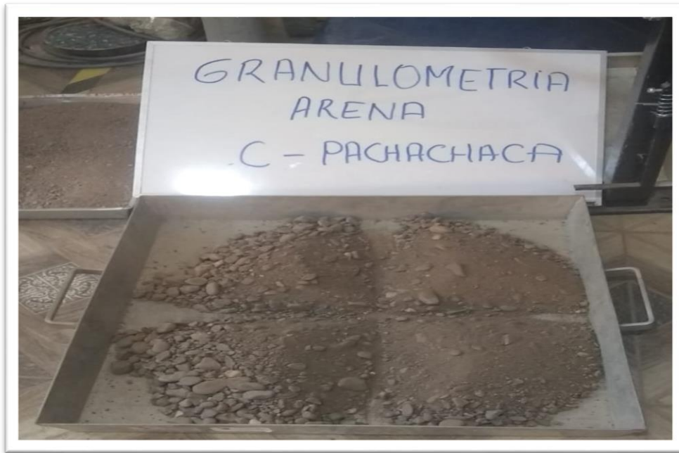
Figura F.32 Cuarteo para la granulometria del agregado fino – cantera Pachachaca.
