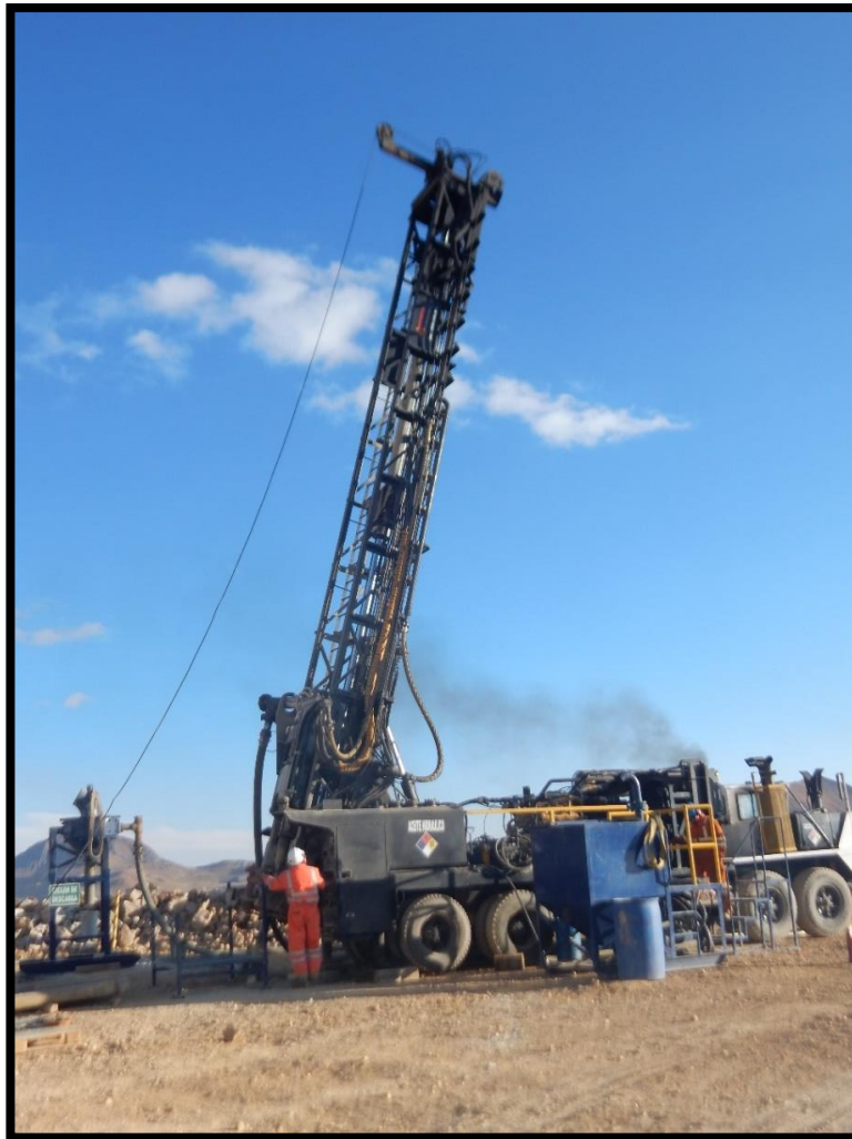
Fig. 10 Perforadora montada en camión modelo DH40 K1 Fuente: Unidad Minera Corihuarmi
