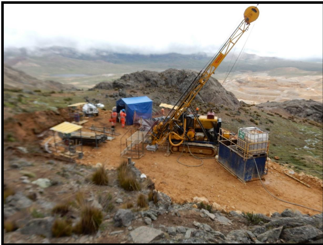
Fig. 9 Perforadora atlas copco modelo CS-14 Fuente: Unidad Minera Corihuarmi
