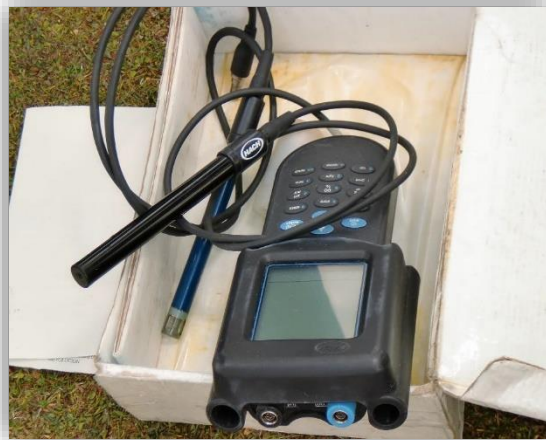
Fig 3 Equipo Hach para el análisis de agua insitu
