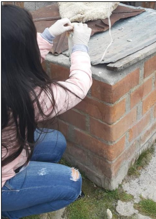
Fotografía 9. Fijando cubierta protectora de papel kraft Pozo muestreado N° 2
