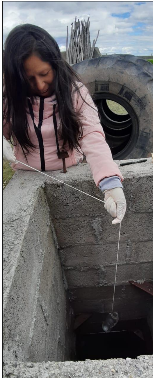
Fotografía 6. Toma de muestra, uso de cordón de nylon
