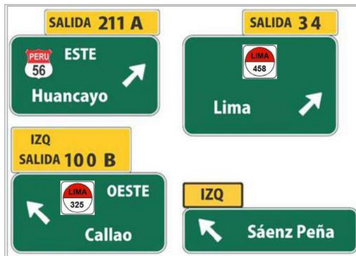
Imagen 28. Ejemplos de señales de dirección de salida en autopistas.
