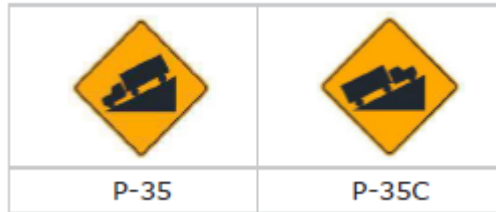
Imagen 17. Señales preventivas – pendiente longitudinal
