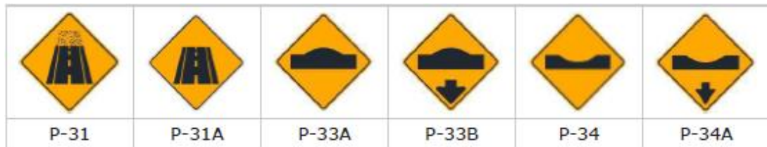
Imagen 18. Señales Preventivas por características de la superficie de rodadura
