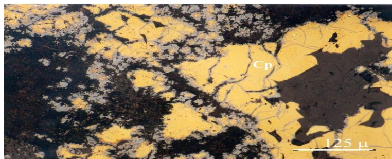
Figura 11: Calcopirita (Cp) parcialmente alterada a calcosina en bordes de grano y fisuras
