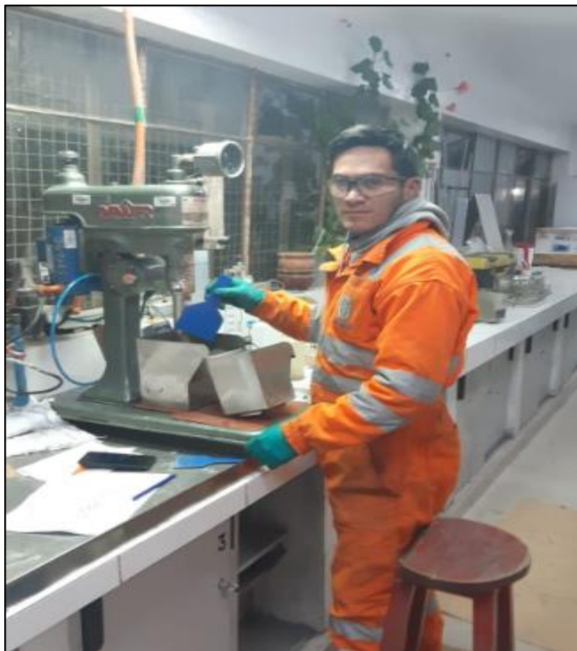
Pruebas de flotación
