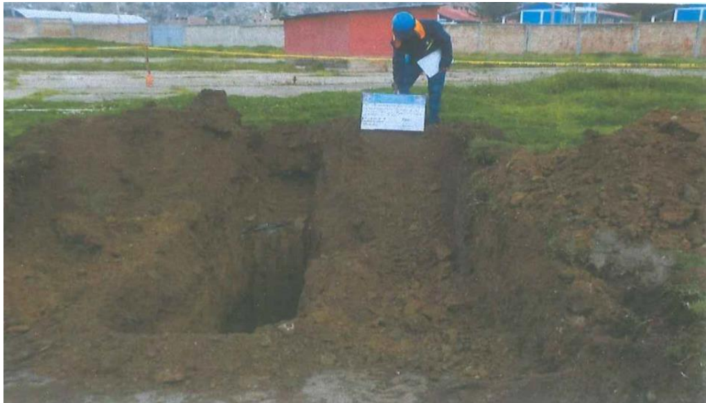
Fotografía 9: vista de la calicata N° 10 con profundidad de 6 m. UTM 478150 m. E y 8665312 m. N
