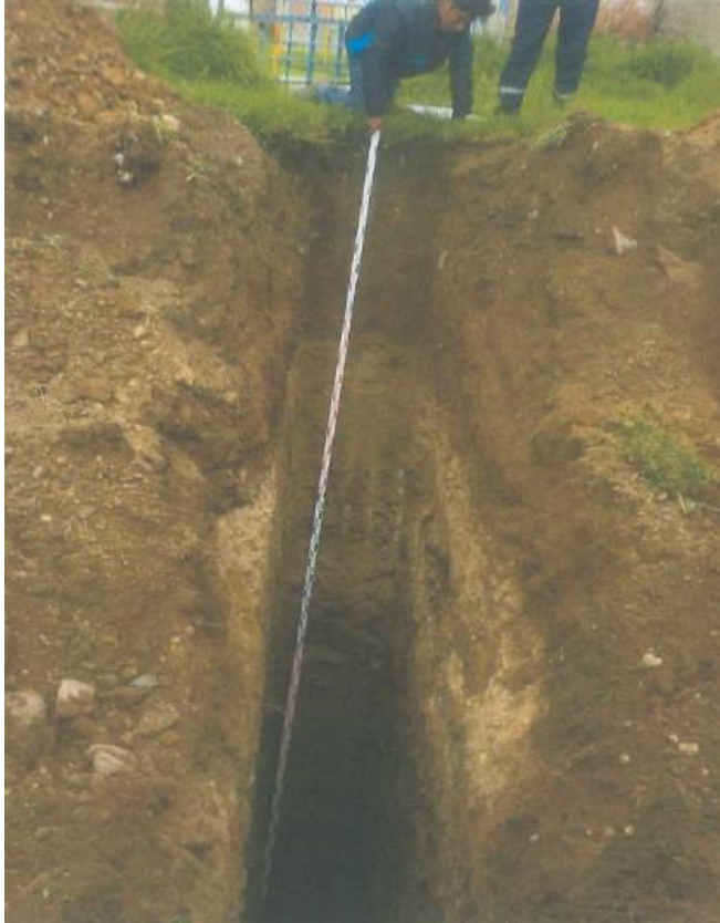
Fotografía 3: Vista de la calicata N° 01 con profundidad de 6 m. UTM 477 971 m. E y 8 665 323 m. N.
