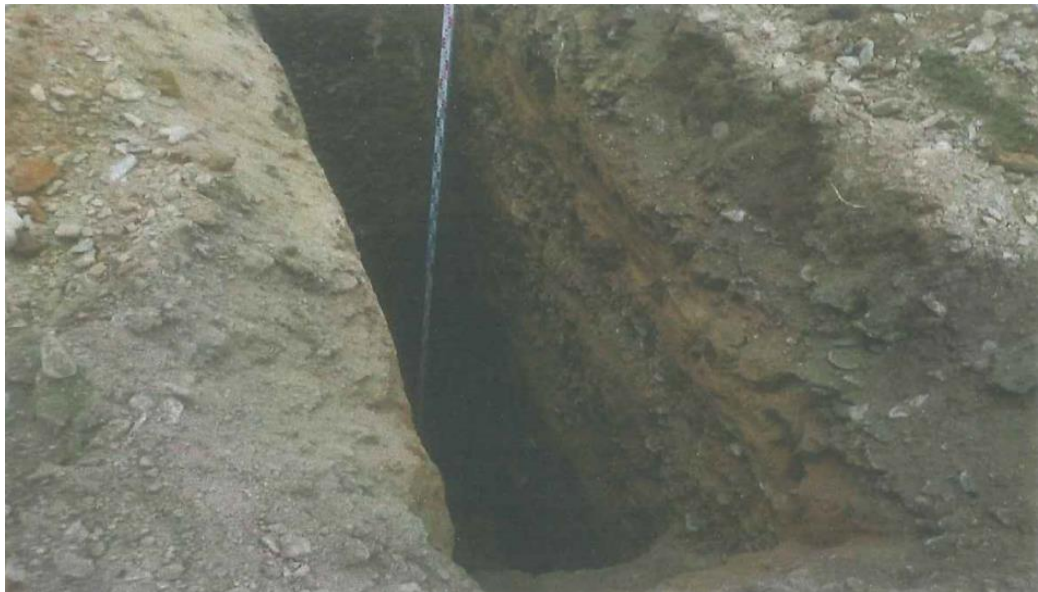
Fotografía 8: vista de la calicata N° 06 con profundidad de 6 m. UTM 478036 m. E y 8665278 m. N
