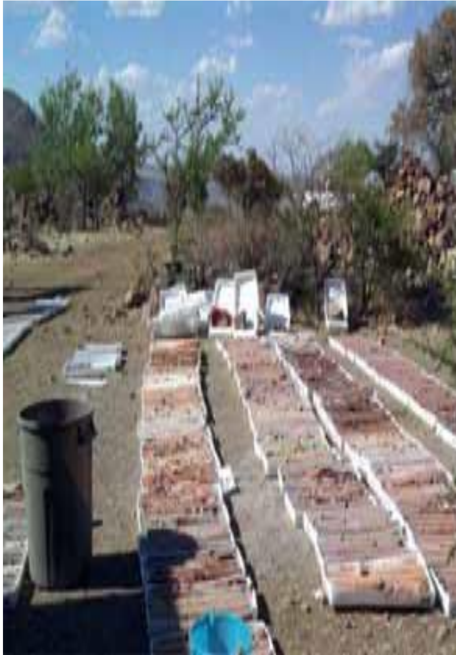
Figura 5. Núcleos de roca obtenidos durante la barrenación, éstos se colocan de manera ordenada para su análisis.
