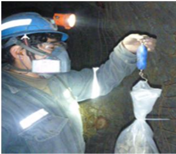
Fig. 2.7. Etiquetado, pesado y amarrado de las bolsas con muestras.
