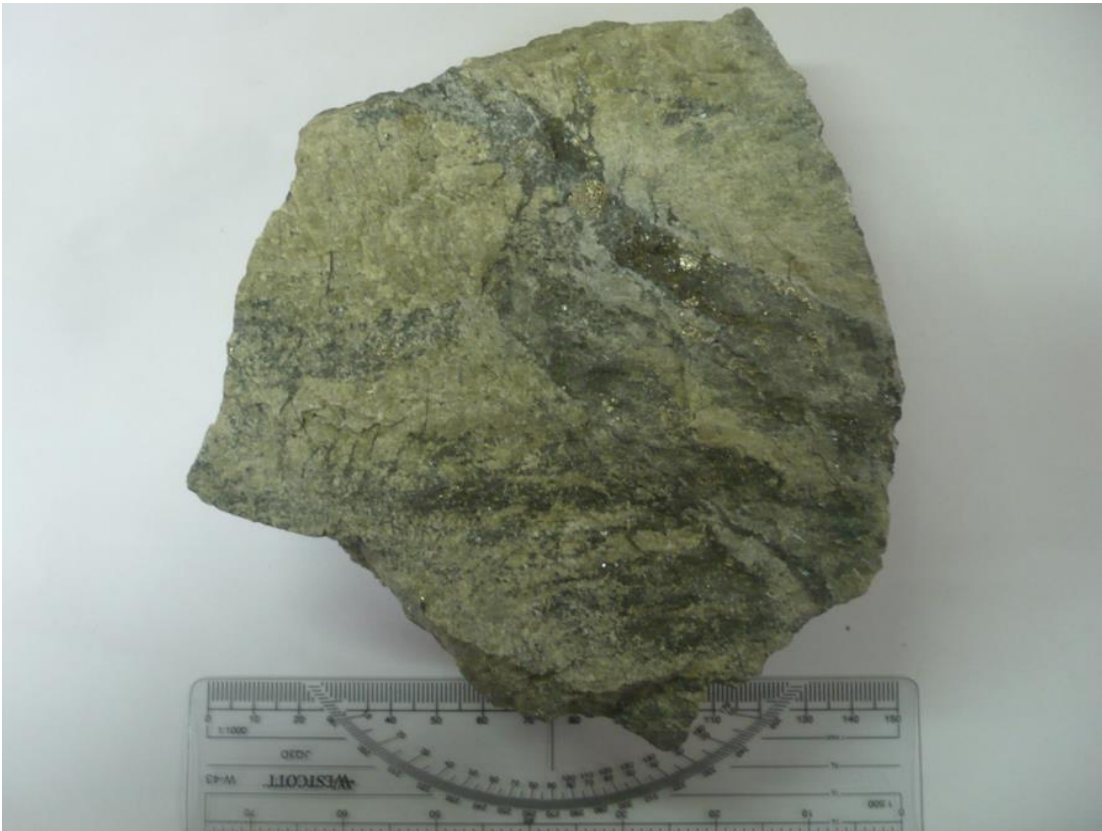
Fig. 4.13 Muestra de mano de Skarn de granates verdes con diss de Sp, Gn y Py.
