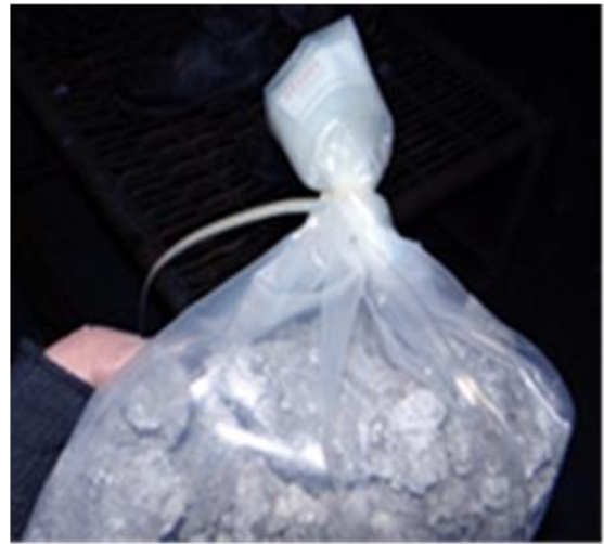
Fig. 2.7. Etiquetado, pesado y amarrado de las bolsas con muestras.
