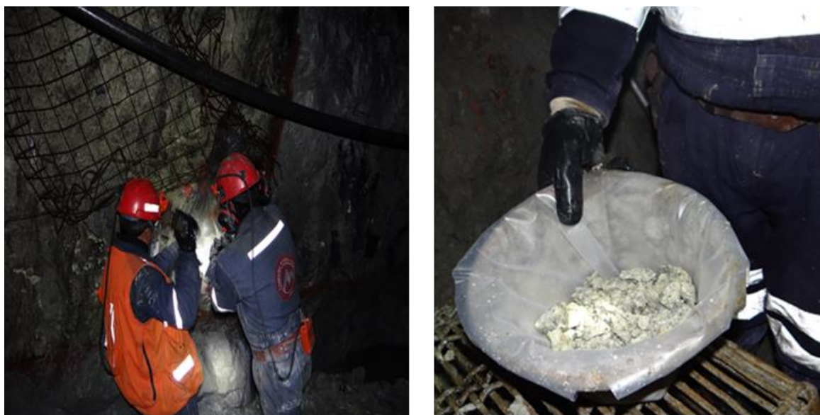
Fig. 2.6. Recolección de muestras con las herramientas y EPP's adecuadas.
