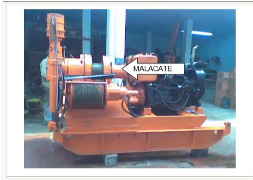
FIGURA 7. Martinete ensayo normal de penetracion.
