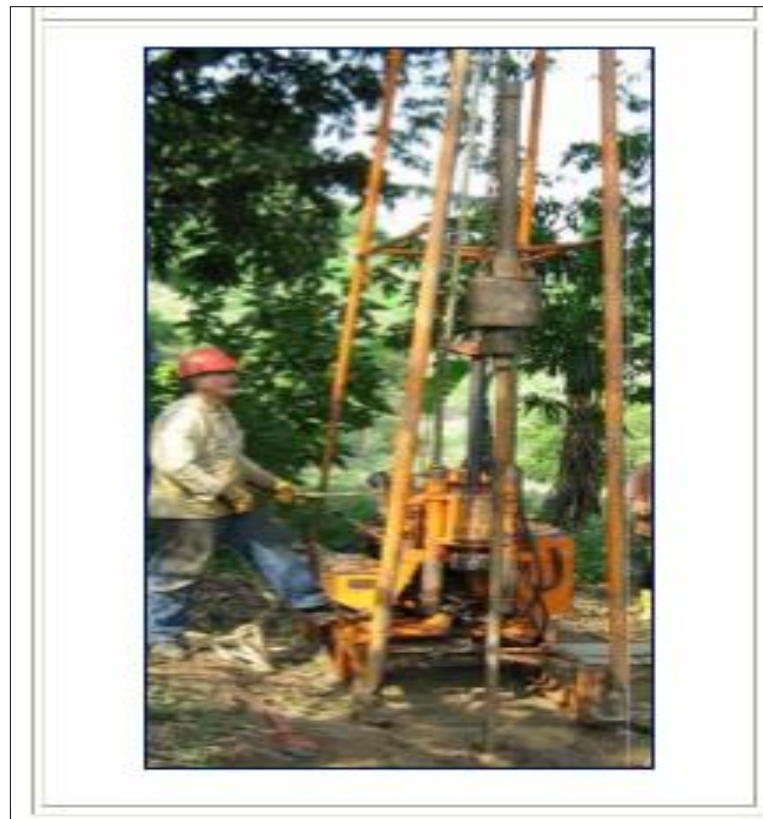
FIGURA 3. Ensayo normal de penetracion
