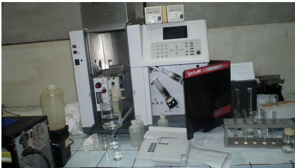
Fig 10 Equipo de Absorción Atómica de la UNAS
