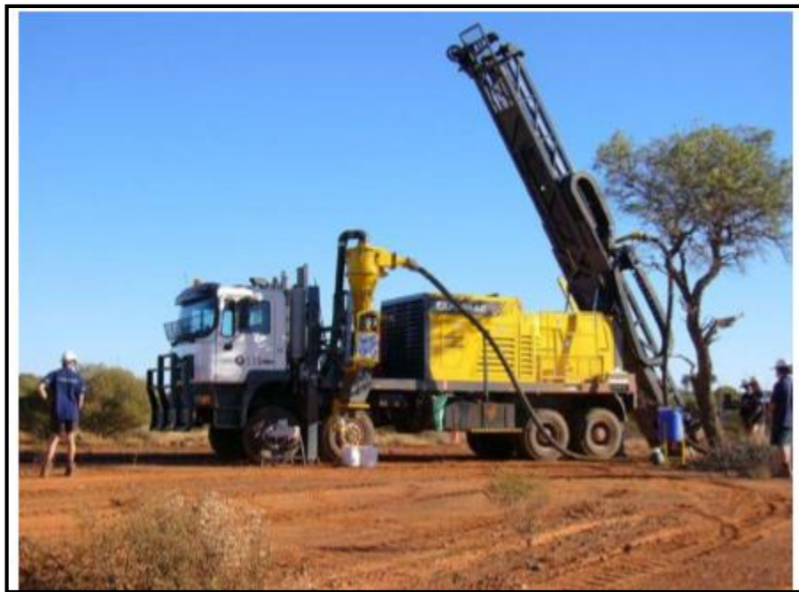
Imagen 01. Equipo de perforación a rotación para exploración minera (Atlas Copco) de "aspiración". De este modo el lodo asciende por el interior del varillaje, arrastrando el detritus de perforación hasta el exterior.
