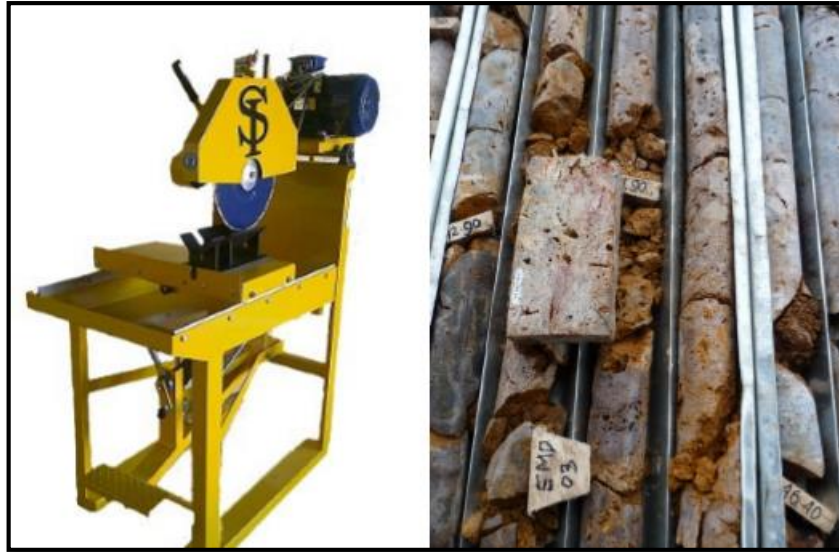
Imagen 06. Sierra de disco para testigos de roca (Fuente: Strength Int. y E.A. Minerals)
