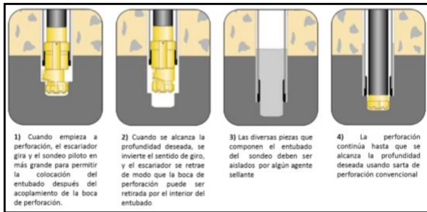
Figura 12. Fundamento del sistema ODEX (Adaptado de DPMF)
