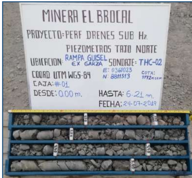
Imagen N° 26 Resultado de testigos de perforación.
