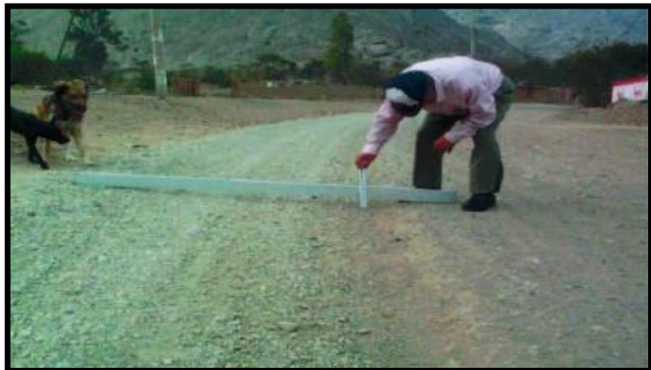
*Figura 4: Deformación, Gravedad 2: Huella/ hundimiento entre 5cm y 10 cm.*
