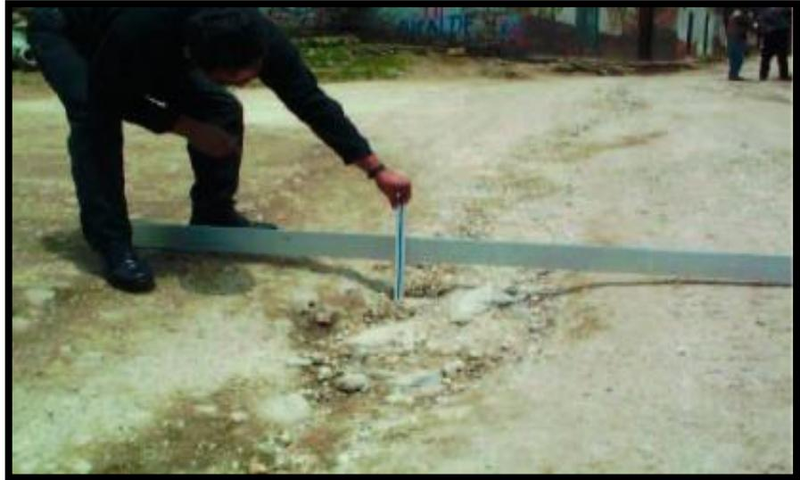
*Figura 8: Erosión, Gravedad 3: Profundidad  $\geq 10$  cm.*
