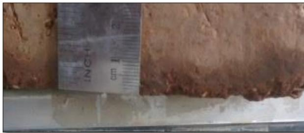
*Ilustración 7. Ascenso capilar del agua en la muestra del adobe normal.*
