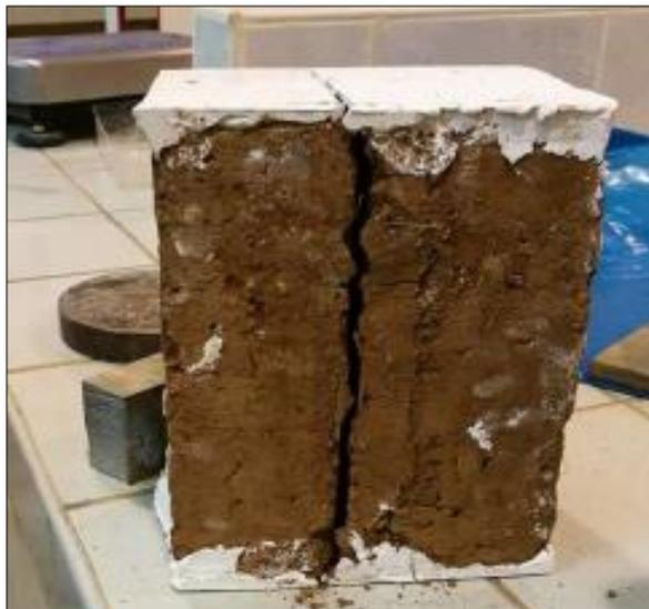
**Ilustración 11.** Falla del mortero en muestras de adobe normal.
