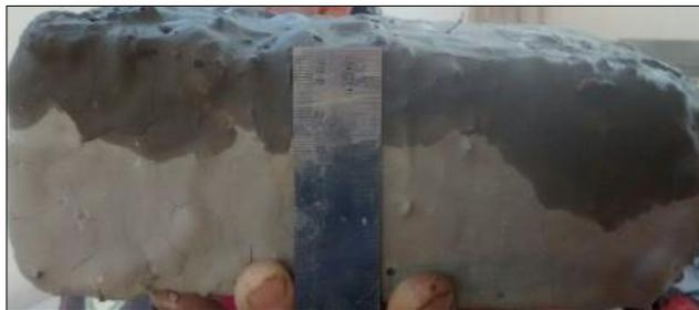
*Ilustración 8. Ascenso capilar del agua en la muestra del adobe sumergido en lechada Agua-cemento.*
