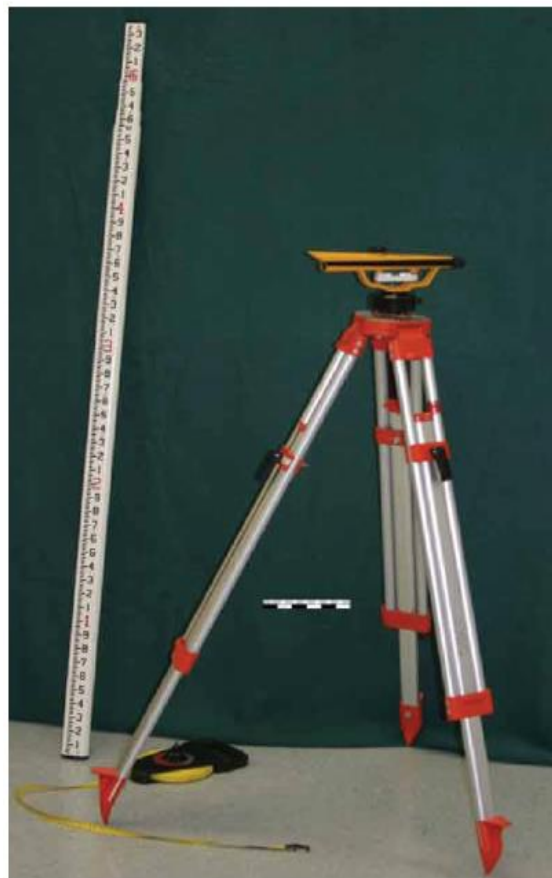
Figura 5: Nivel y mira topográfica
