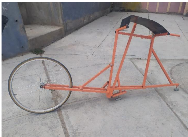
Figura 11: Rugosímetro de MERLIN empleado para los ensayos en esta tesis.
