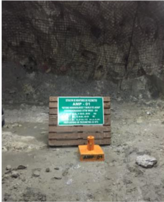
Fotografía 1: Piezómetro tipo Casagrande AMP-01, ubicado en el nivel 200 hacia el norte cerca al crucero 120 de interior mina.
