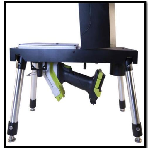
*Figura N° 8.* Ubicación del analizador en el banco de pruebas
