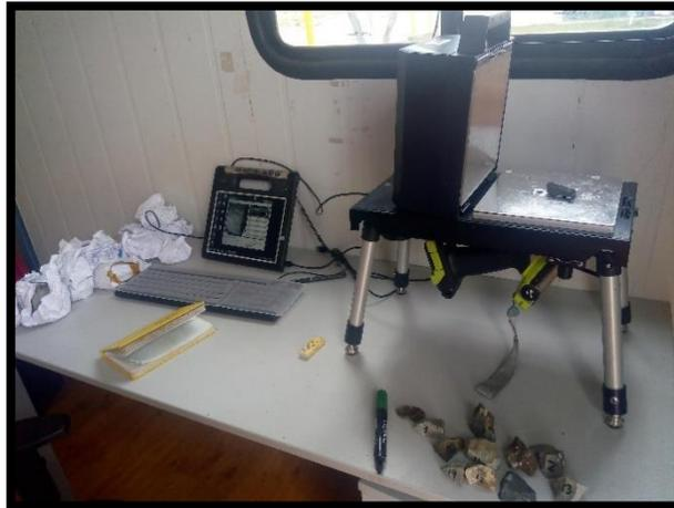
*Figura N° 43. Analizador XRF Portátil Niton XI5 y banco de pruebas.*
