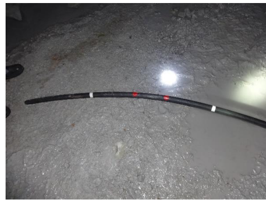
Figura: 63 Marcado de manguera de carguio.
