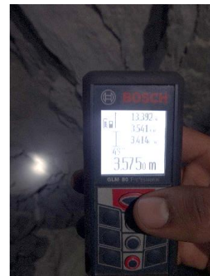
Figura: 69 Medición de avance.
