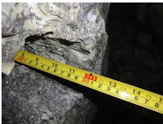
Figura: 64 Tacos 20cm despues de la voladura.
