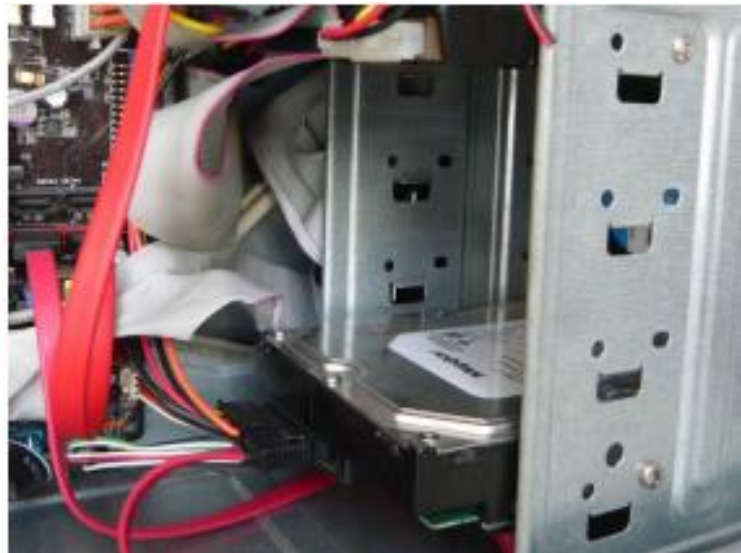
Imagen 3: Disco Duro dentro de una Torre de PC.
