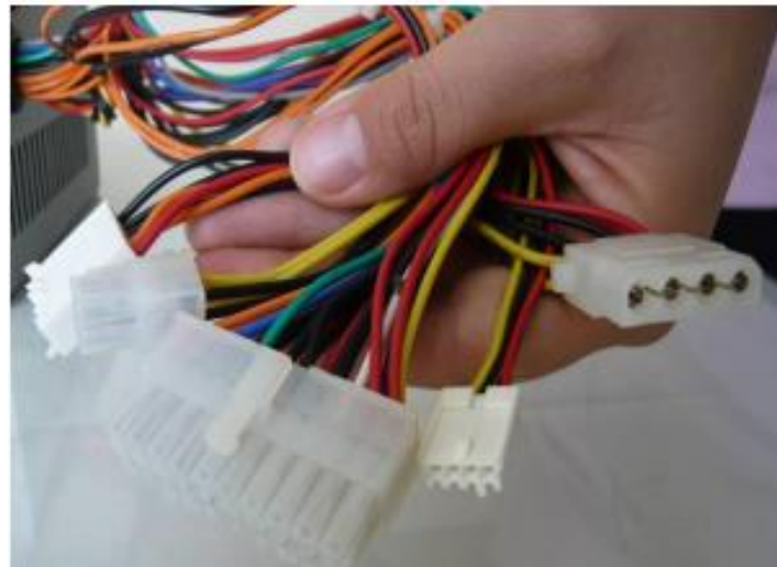
Imagen 9: Conector Molex a la derecha, seguido del P4 y el ATX.
