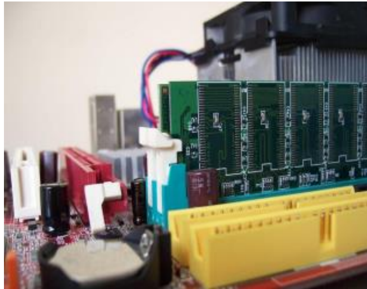
Imagen 25: Seguros de las muescas laterales de los Slots para RAM.
