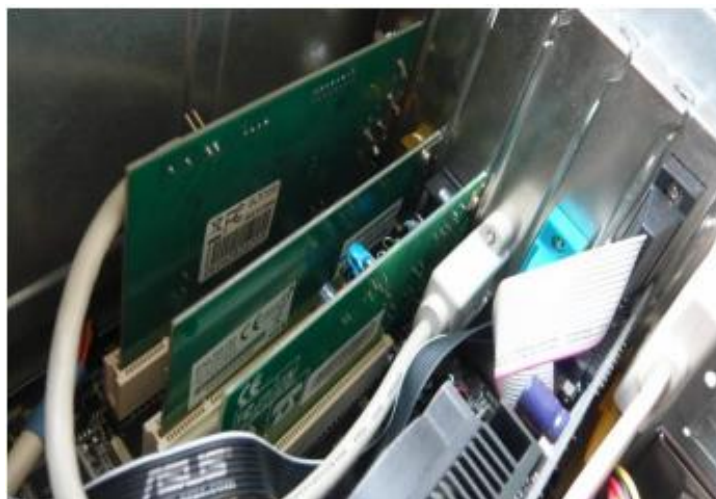
Imagen 7: Tarjetas de expansión Instaladas.
