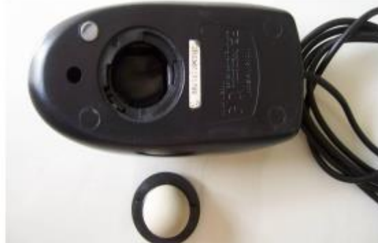
Imagen 16: Ratón Mecánico (Parte Inferior y rodillos)
