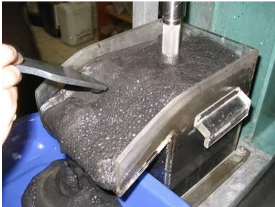
Ilustración 10 – Extracción del concentrado en la etapa de flotación
