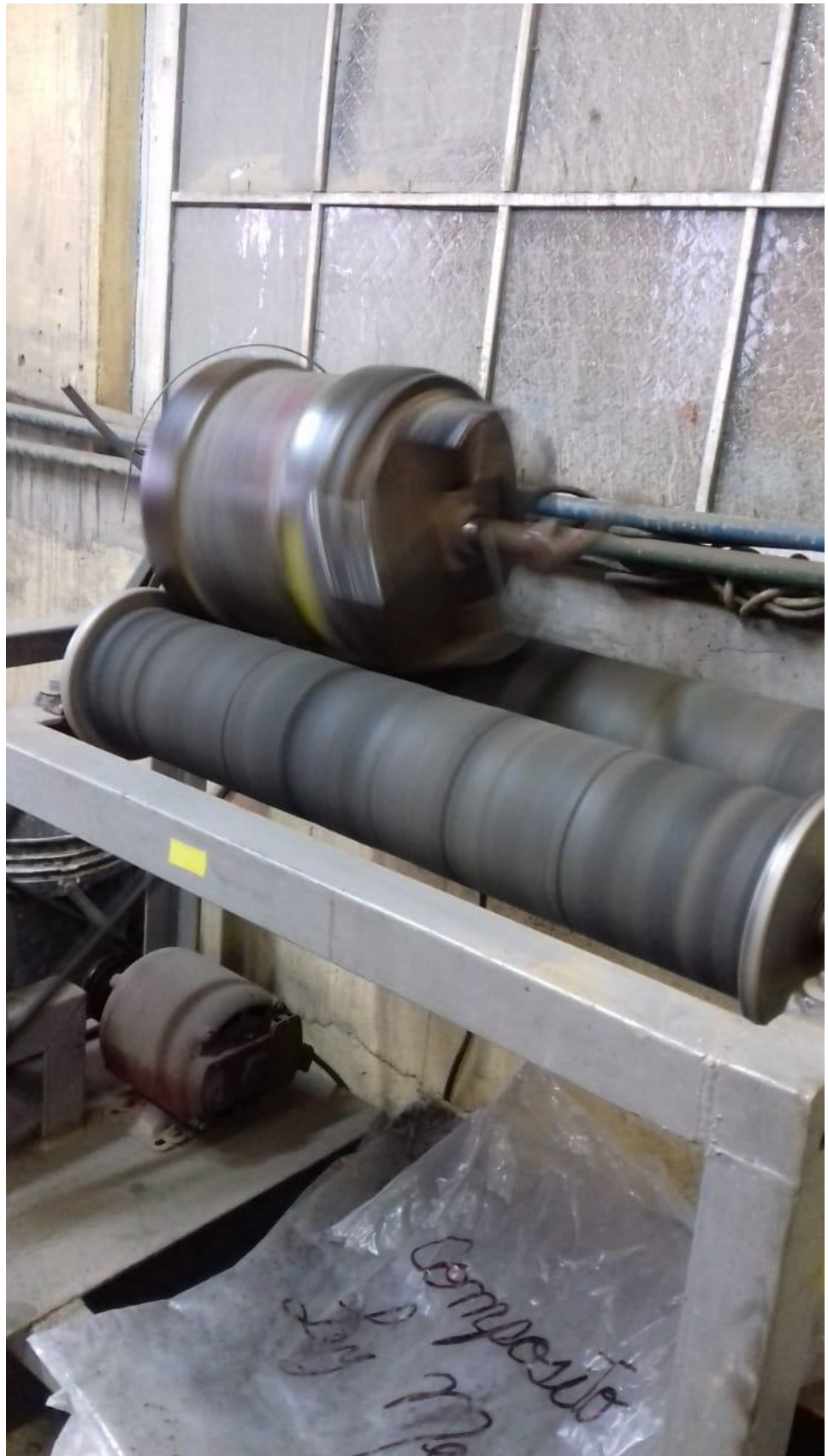
Ilustración 7 - Molienda del mineral marginal
