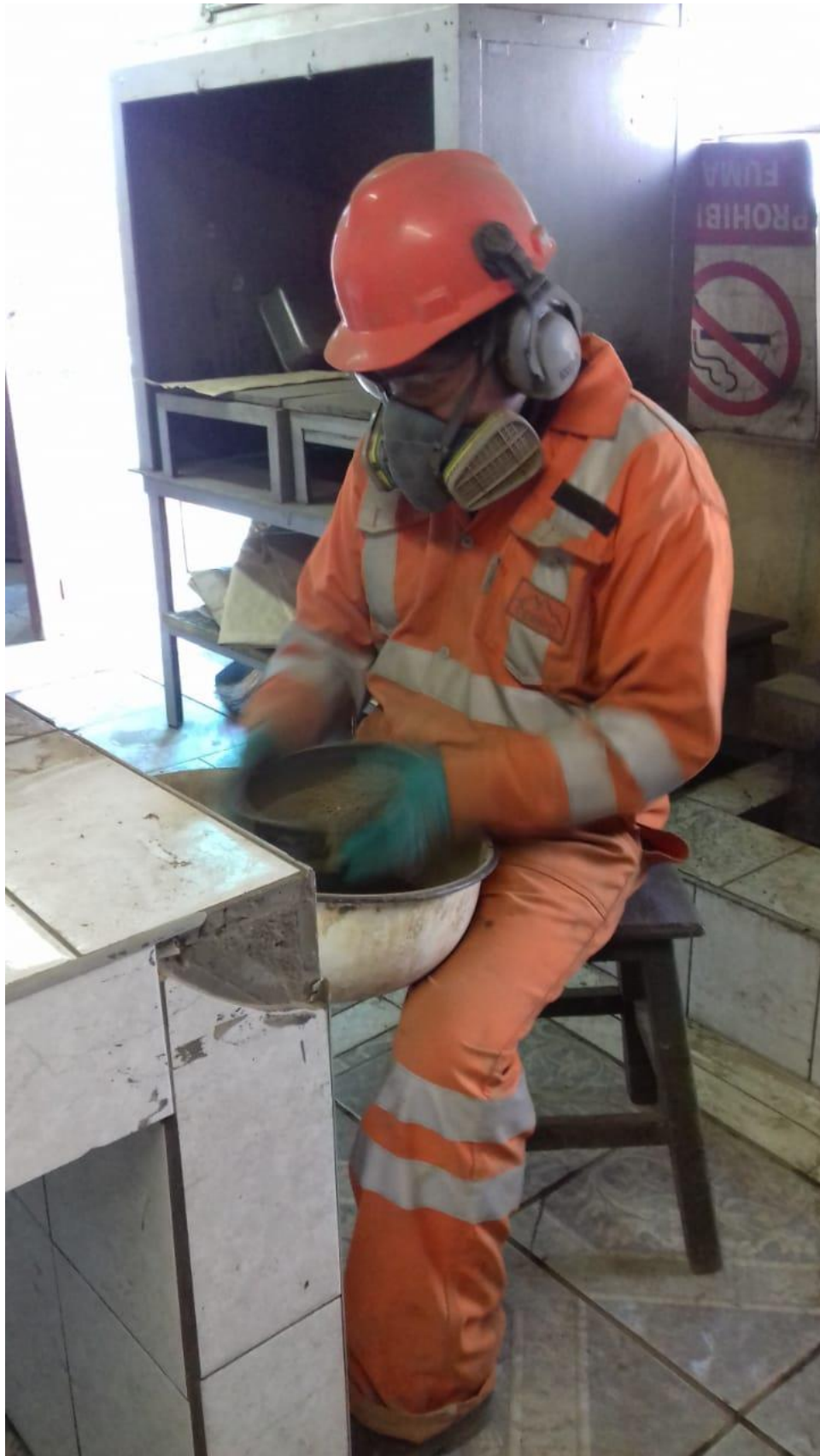
Ilustración 3 – Preparación mecánica del mineral marginal en el laboratorio
