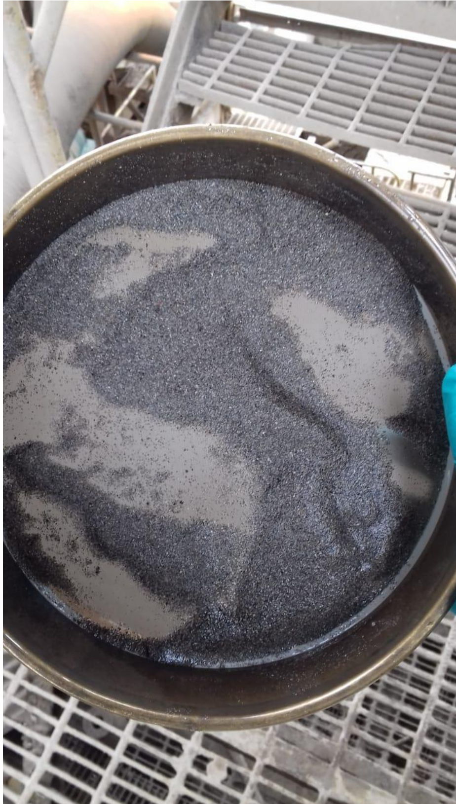
Ilustración 8 – Verificación de la granulometría de la etapa de molienda
