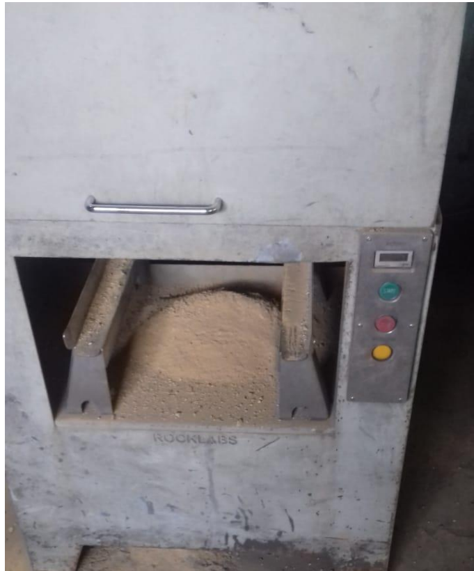
Ilustración 6 – Procesamiento secundario por la chancadora de rodillos
