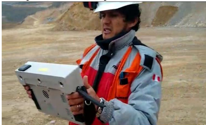
Figura 13: Monitoreo de Fragmentación con Portametrics
