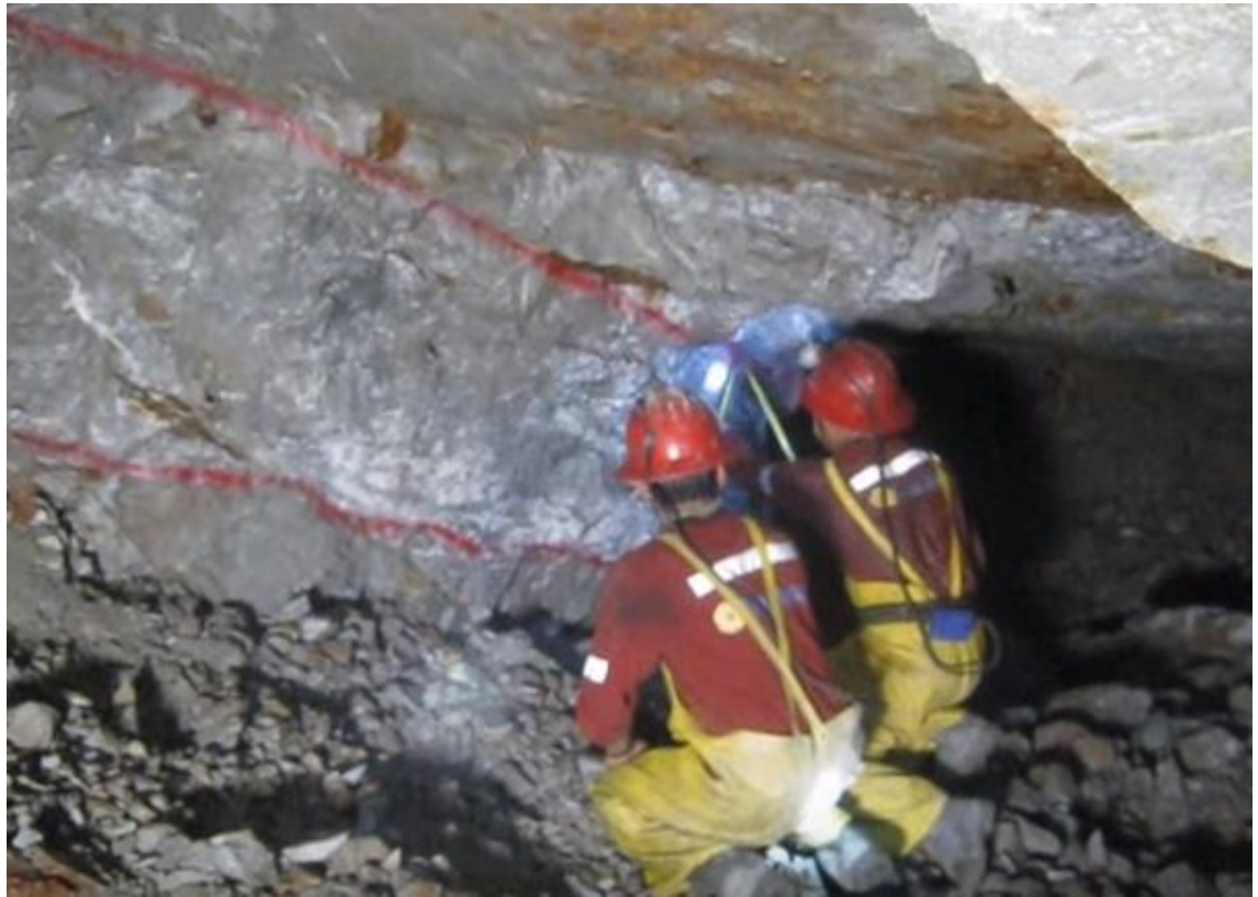
Pintado y señalización de vetas angostas – Area de Geología Minera Casapalca.
