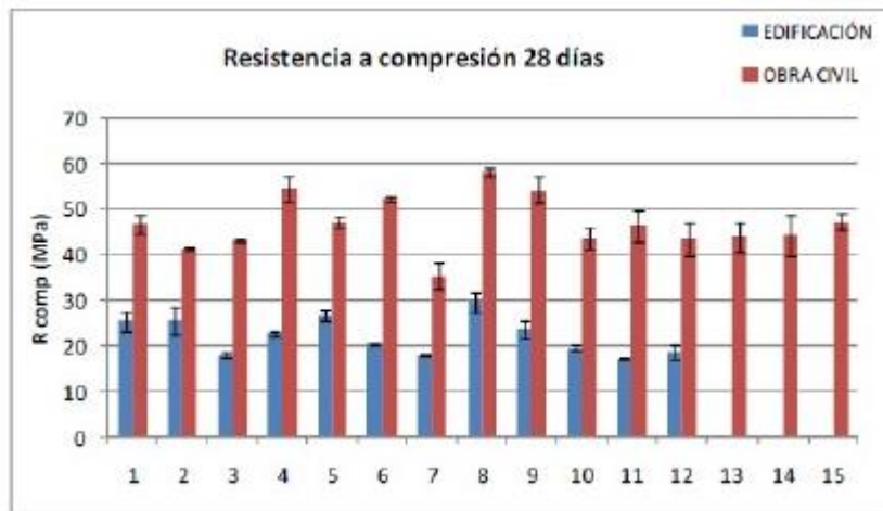
Figura: Resistencia a la compresión de los concreto estudiados
