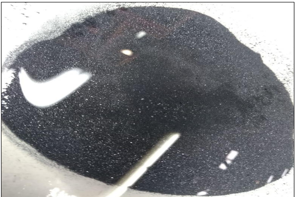
Plateado de espumas celda unitaria II, después del cambio de adición del colector AR-
