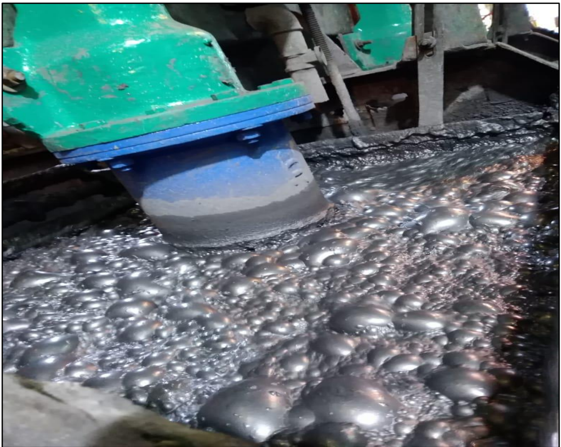
Espumas de celdas unitarias I y II después del cambio de adición del colector AR-3418
