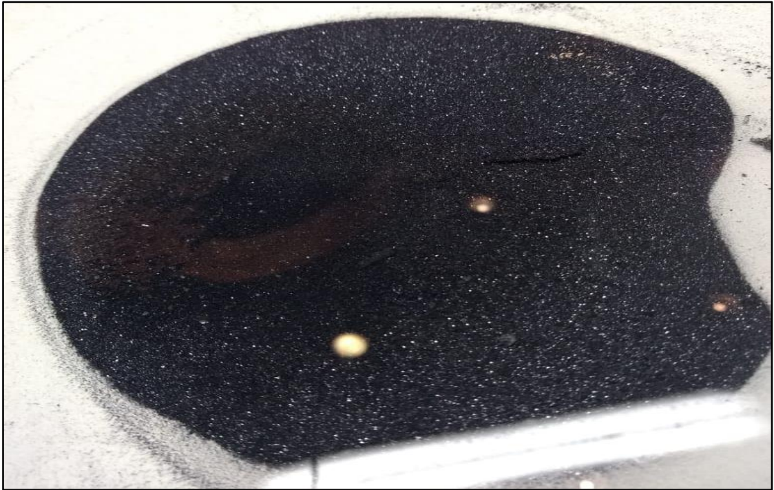
Plateado de espumas celda unitaria I, después del cambio de adición del colector AR-
