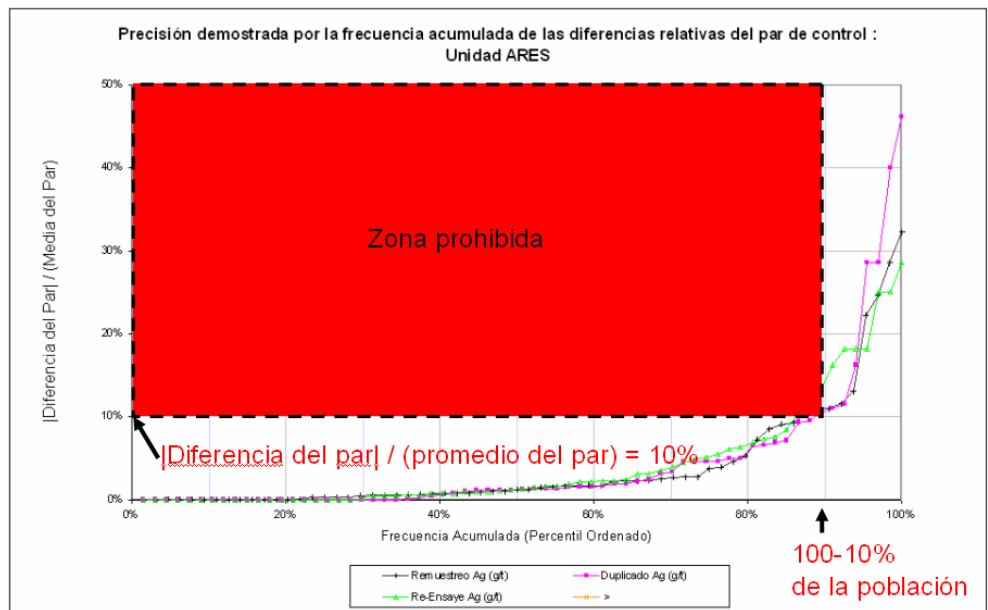
FIGURA N° 12: Diagrama para el análisis de datos de duplicados finos (re-ensayos, verde). Se permite una diferencia del par de >10% para un 10% de la población. Tomada del estándar de QA/QC de la corporación: SIG-EST-GEO04-10-00
