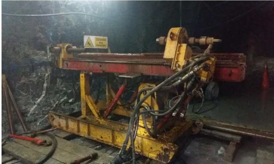
FOTO N° 10: Máquina perforadora GEO 55 de dimensiones pequeñas para acomodarse a una sección de 4.5 x 4
