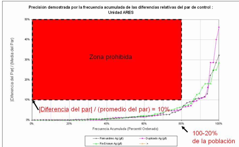
FIGURA N° 11: Diagrama para el análisis de datos de duplicados gruesos (magenta). Se permite una diferencia del par de >10% para un 20% de la población. Tomada del estándar de QA/QC de la corporación: SIG-EST-GEO04-10-00
