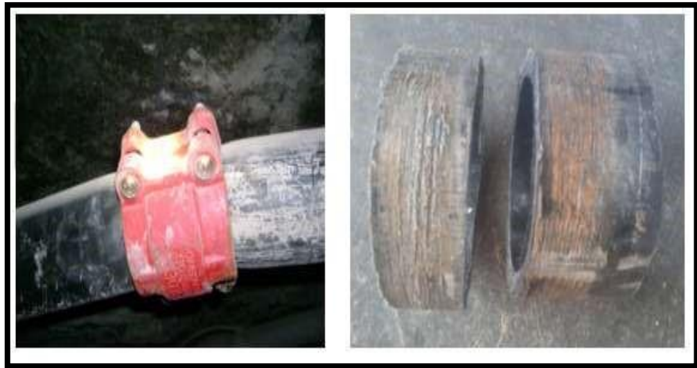
Gráfico N° 07. Desgaste de tubería en los puntos de empalme
