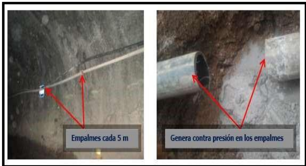
Gráfico N° 08. Desgaste de tuberías en la superficie externa de los puntos de unión de unión
