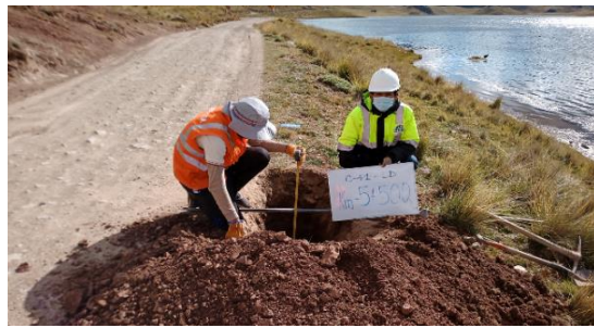
Fotografía N°C-41a: Vista de Calicata C-41 en la progresiva 5+500, profundidad: 0.85 m.
