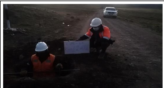
Fotografía N°C-25a: Vista de Calicata C-25 en la progresiva 12+000, profundidad: 1.5 m.
