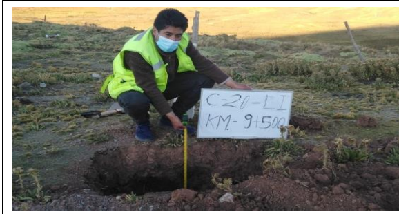
Fotografía N°C-20a: Vista de Calicata C-20 en la progresiva 09+500, profundidad: 1.5 m.
