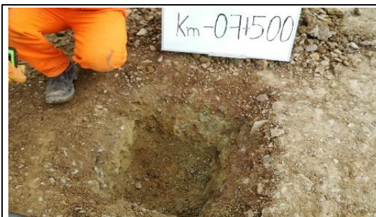
Fotografía N°C-16a: Vista de Calicata C-16 en la progresiva 7+500, profundidad: 1.5 m.
