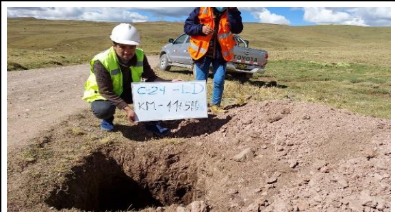
Fotografía N°C-24a: Vista de Calicata C-24 en la progresiva 11+500, profundidad: 1.5 m.
