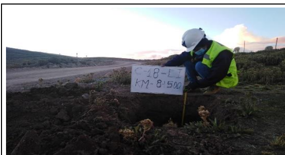
Fotografía N°C-18a: Vista de Calicata C-18 en la progresiva 08+500, profundidad: 1.5 m.
