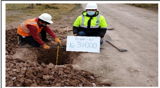
Fotografía N°C-36a: Vista de Calicata C-36 en la progresiva 3+000, profundidad: 1.5 m.
