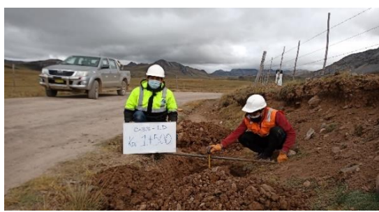
Fotografía N°C-33a: Vista de Calicata C-33 en la progresiva 1+500, profundidad: 1.5 m.
