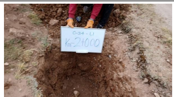
Fotografía N°C-34b: Se observa la Calicata C-34, ubicada al lado izquierdo de la vía.
