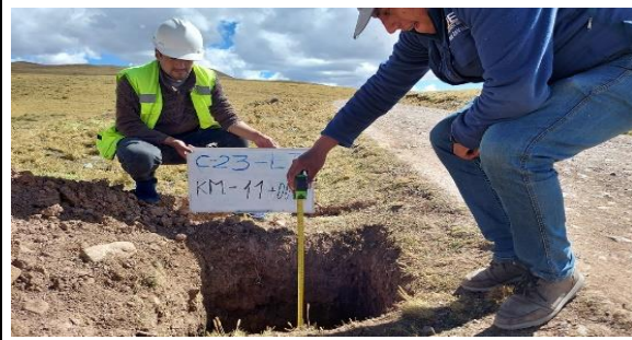
Fotografía N°C-23a: Vista de Calicata C-23 en la progresiva 11+000, profundidad: 1.5 m.
