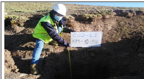
Fotografía N°C-22a: Vista de Calicata C-22 en la progresiva 10+500, profundidad: 1.5 m.
