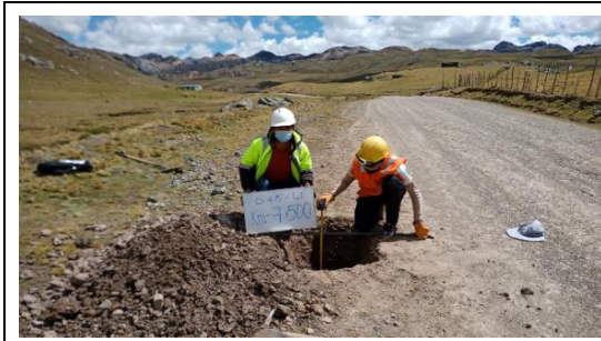
Fotografía N°C-45a: Vista de Calicata C-45 en la progresiva 7+500, profundidad: 0.50 m.
