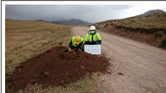
Fotografía N°C-31a: Vista de Calicata C-31 en la progresiva 0+500, profundidad: 1.5 m.
