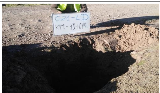
Fotografía N°C-21b: Se observa la Calicata C-21, ubicada al lado derecho de la vía.
