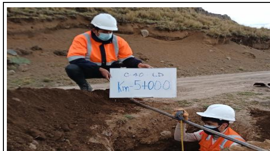
Fotografía N°C-40a: Vista de Calicata C-40 en la progresiva 5+000, profundidad: 1.5 m.
