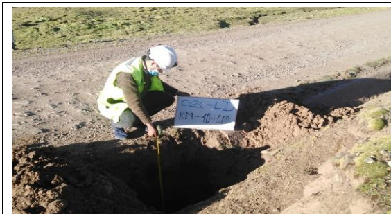
Fotografía N°C-21a: Vista de Calicata C-21 en la progresiva 10+000, profundidad: 1.5 m.
