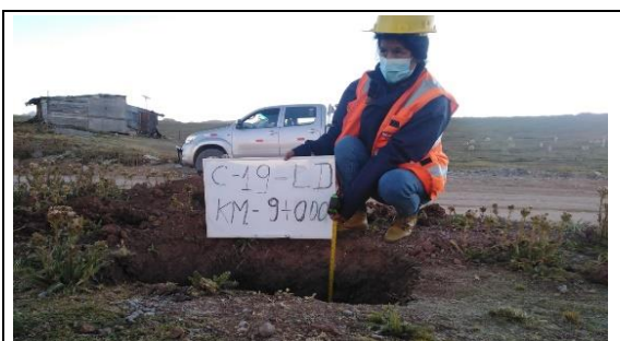
Fotografía N°C-19a: Vista de Calicata C-19 en la progresiva 09+000, profundidad: 1.5 m.
