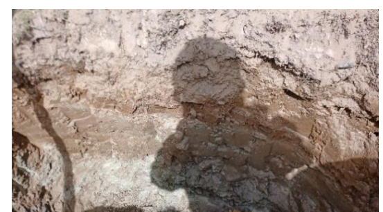
Fotografía N°C-37b: Se observa la Calicata C-37, ubicada al lado derecho de la vía, encontrando roca a la profundidad de 0.9 m.
