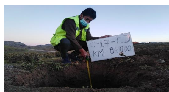
Fotografía N°C-17a: Vista de Calicata C-17 en la progresiva 08+000, profundidad: 1.5 m.
