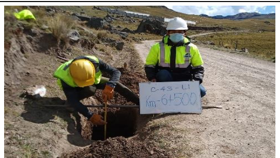
Fotografía N°C-43a: Vista de Calicata C-43 en la progresiva 6+500, profundidad: 1.5 m.
