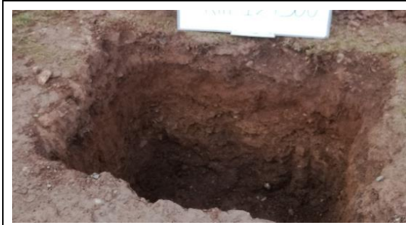
Fotografía N°C-29a: Vista de Calicata C-29 en la progresiva 14+000, profundidad: 1.5 m.
