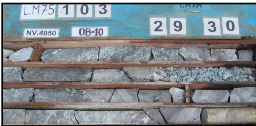
Foto N° 02. Muestra de brecha hidrotermal silícea
