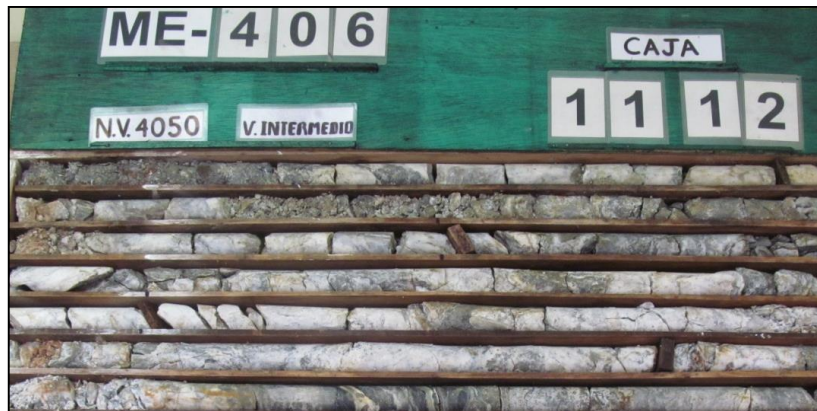
Foto N°06 Muestra de Sílice Wollastonita de textura brechoide.
