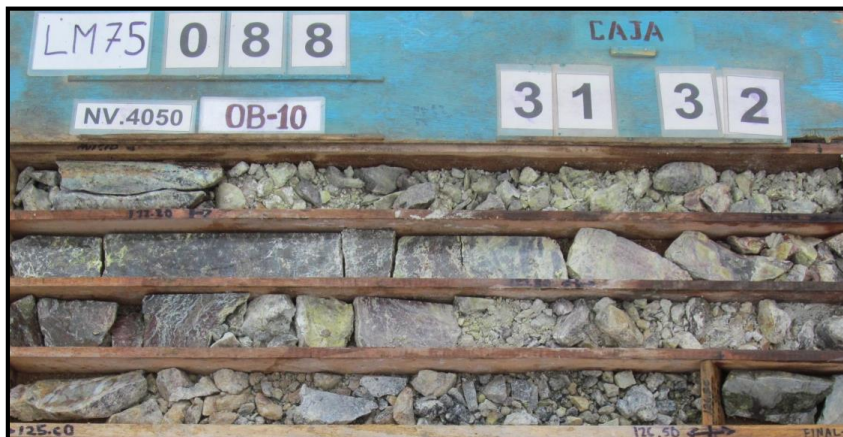
Foto N° 03. Sílice, Skarn, Clorita, con presencia de abundante serpentina y hematita
