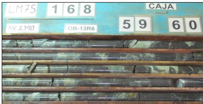
Foto N° 05 Muestra de skarn de granates verdes con reemplazamiento masivo de sulfuros
