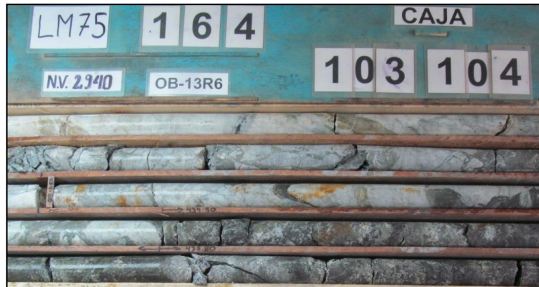
Foto N° 07 Muestra de Mármol con relictos de Caliza y reemplazamiento de sulfuros.
