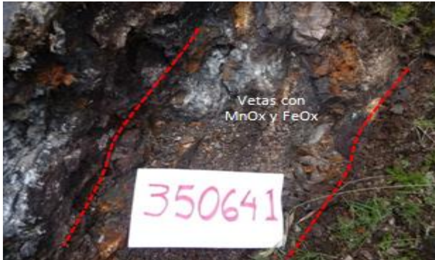
Figura N° 14 Se observa el afloramiento de la veta oxidada de 2m de ancho, rellena con MnOx y FeOx la muestra N° 350641 con: Ag=14.19ppm; Pb=3900ppm; Zn=8000ppm
