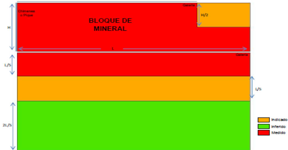
Fig. 12. Consideraciones geométricas para clasificar los Bloques como Reserva de Mena o Recurso Mineral. (Fuente: Autor).
