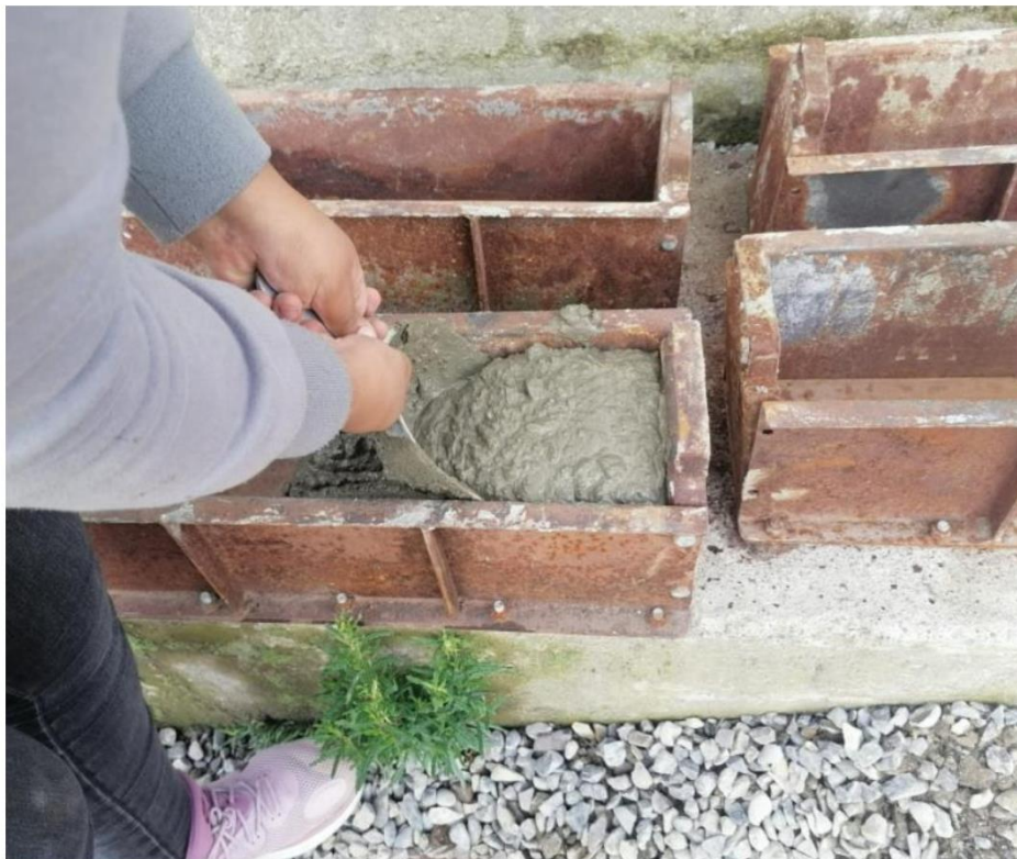
Fotografía 18: Muestras en los moldes para la verificación de los ensayos de flexión.
