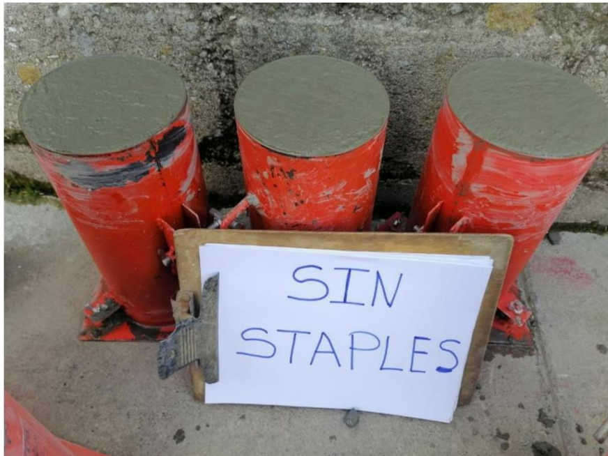
Fotografía 09: Muestras de tres probetas para los ensayos de la resistencia a la compresión.
