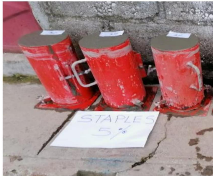
Fotografía 16: Muestras de 3 probetas con la incorporación del staples al 5%.
