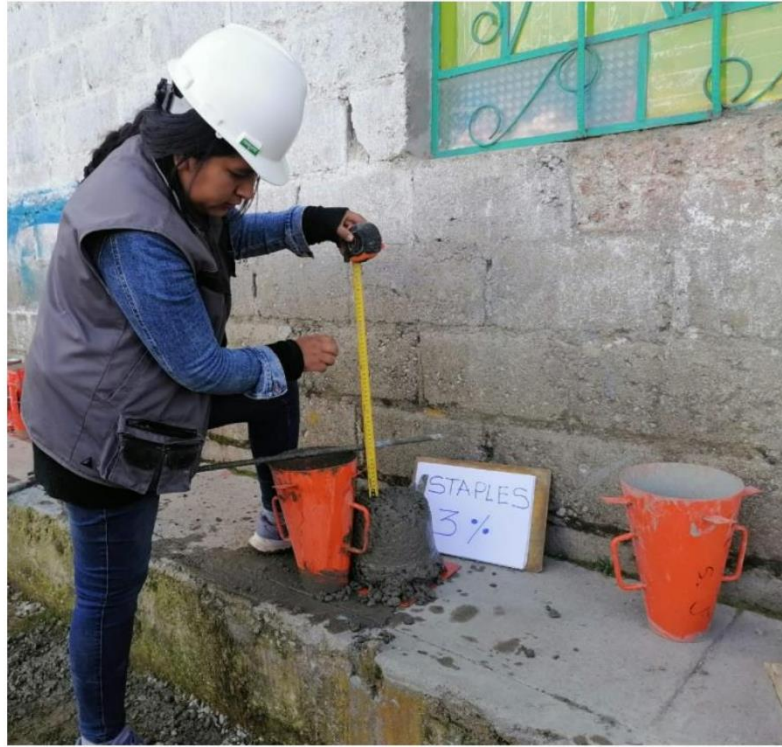
Fotografía 11: Slump del concreto f_c=210\text{kg/cm}^2 con la incorporación de staples de 3%
