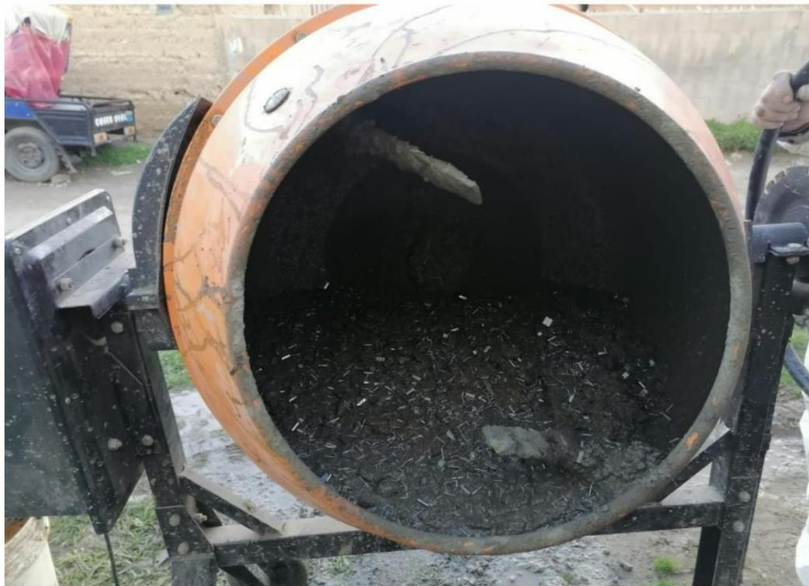
Fotografía 10: Concreto con la incorporación del staples al 3%
