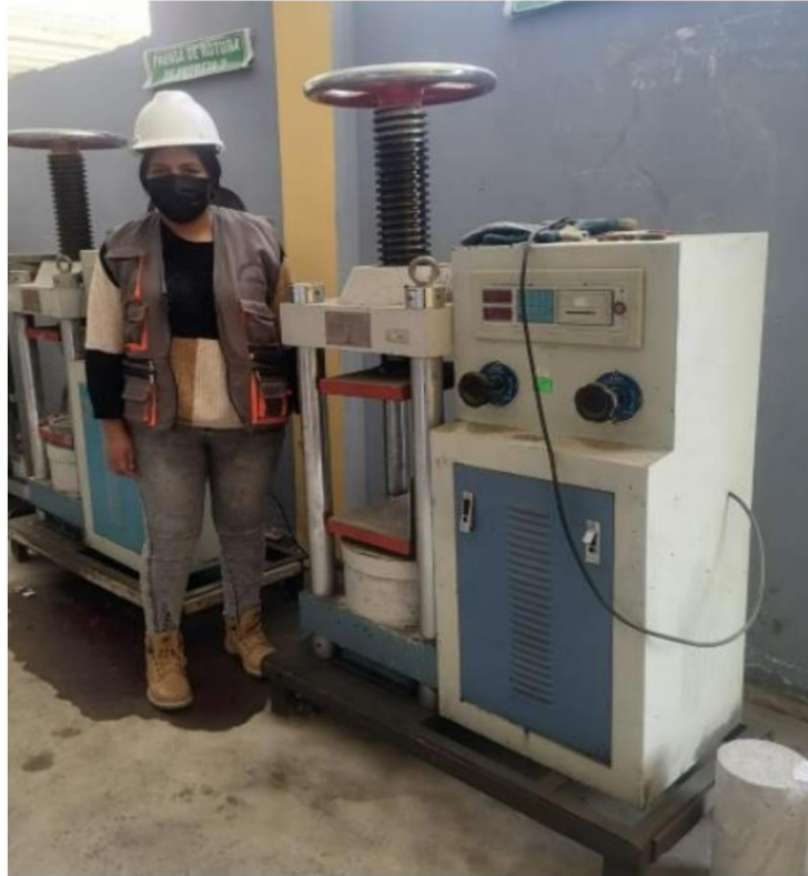
Fotografía 21: Prueba de la comprensión a los 7 días de edad.
