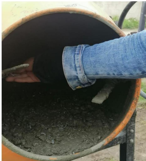
Fotografía 14: Fotografía 10: Concreto con la incorporación del staples al 3%
