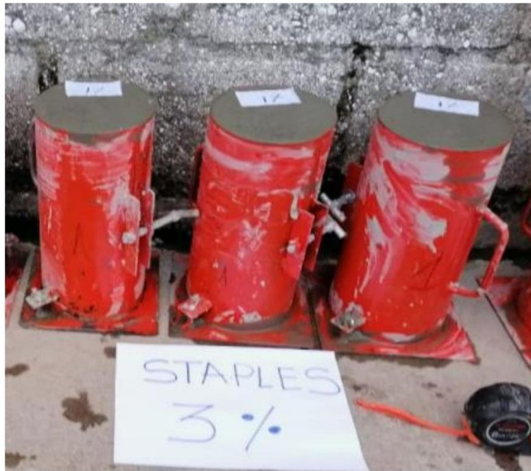
Fotografía 13: Muestras de 3 probetas con la incorporación del staples al 3%
