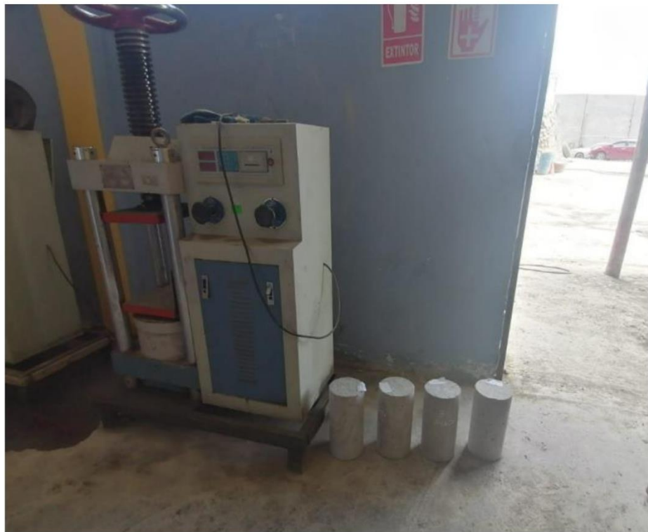
Fotografía 20: Prueba de la comprensión a los 7 días de edad.
