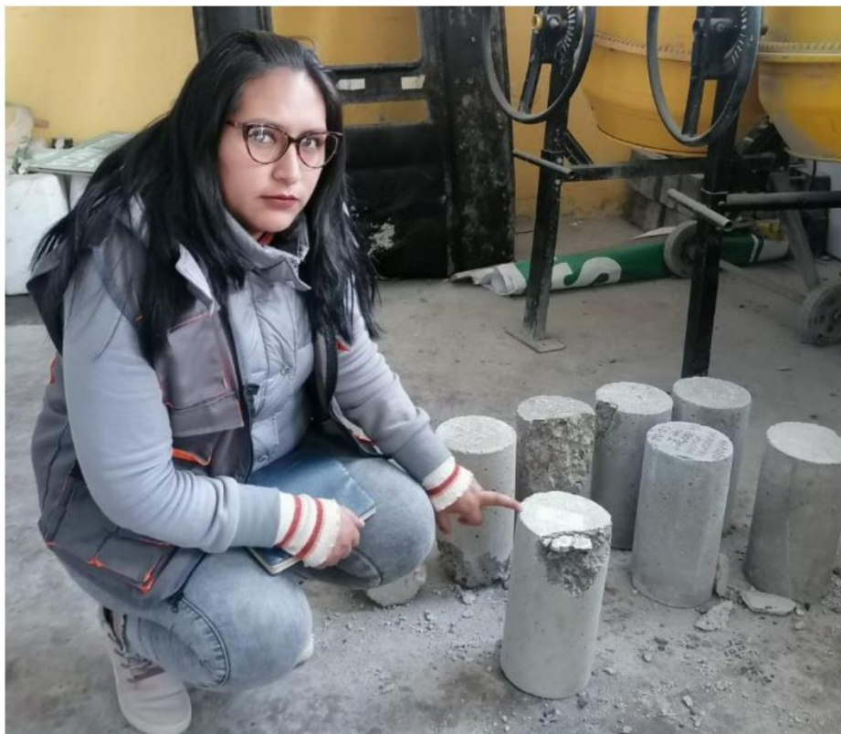
Fotografía 23: Prueba de la comprensión a los 14 días de edad.
