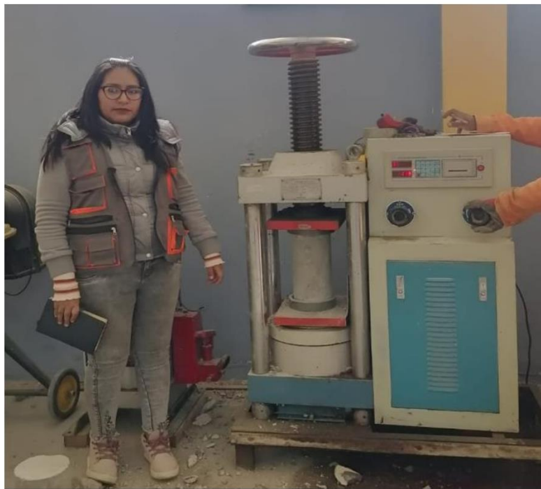
Fotografía 22: Prueba de la comprensión a los 14 días de edad.
