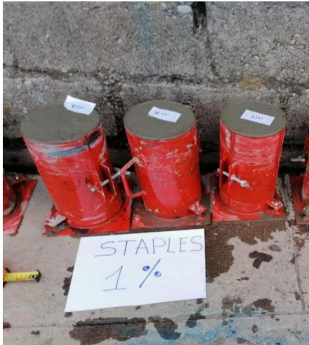
Fotografía 11: Muestras de 3 probetas con la incorporación del staples al 1%
