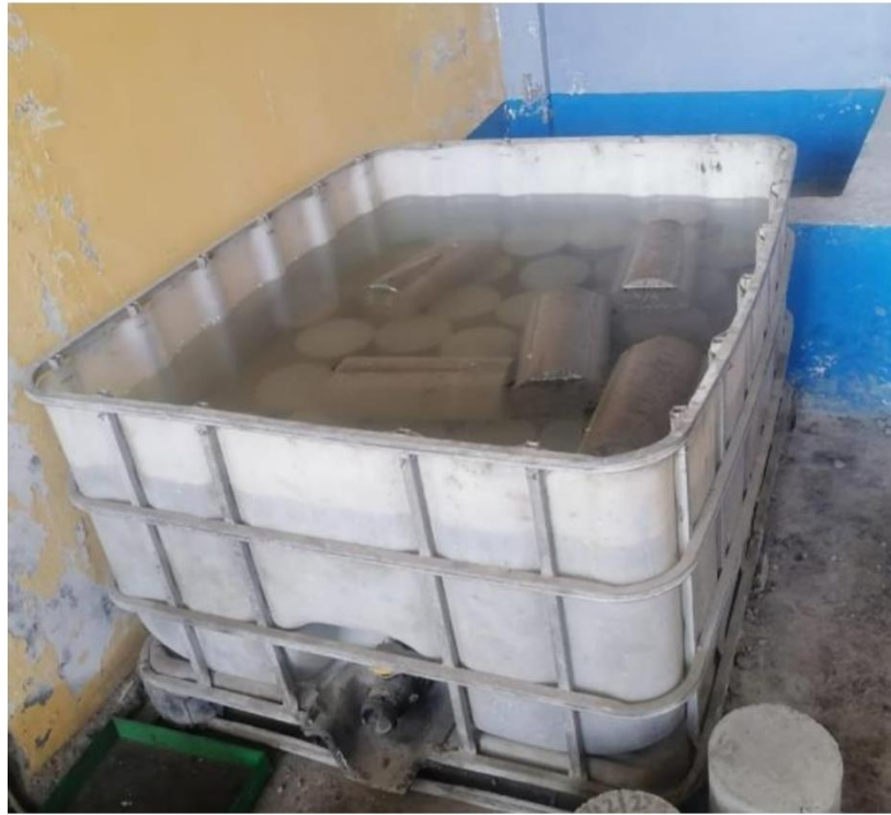
Fotografía 19: Curado de las probetas
