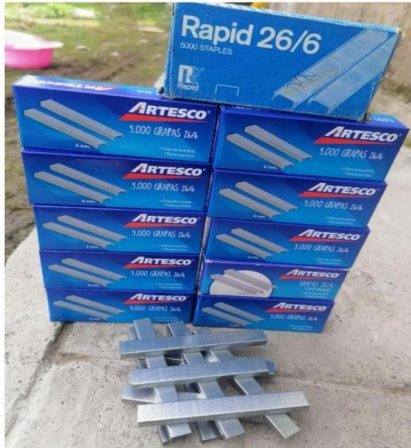
Fotografía 01: Staples para la incorporación al concreto
