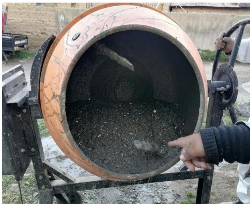
Fotografía 10: Concreto con la incorporación del staples al 1%
