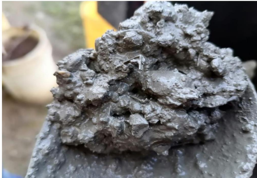
Fotografía 12: Concreto f_c=210\text{kg/cm}^2 con la incorporación de staples al 3%.
