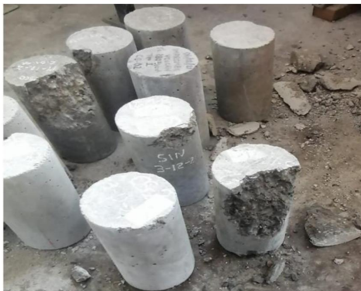
Fotografía 24: Prueba de la comprensión a los 21 días de edad.
