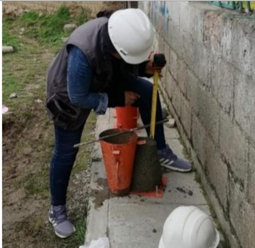
Fotografía 07: Slump del concreto base f_c=210\text{kg/cm}^2
