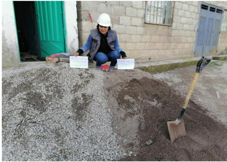
Fotografía 05: Agregados ( piedra chancada y shocre)
