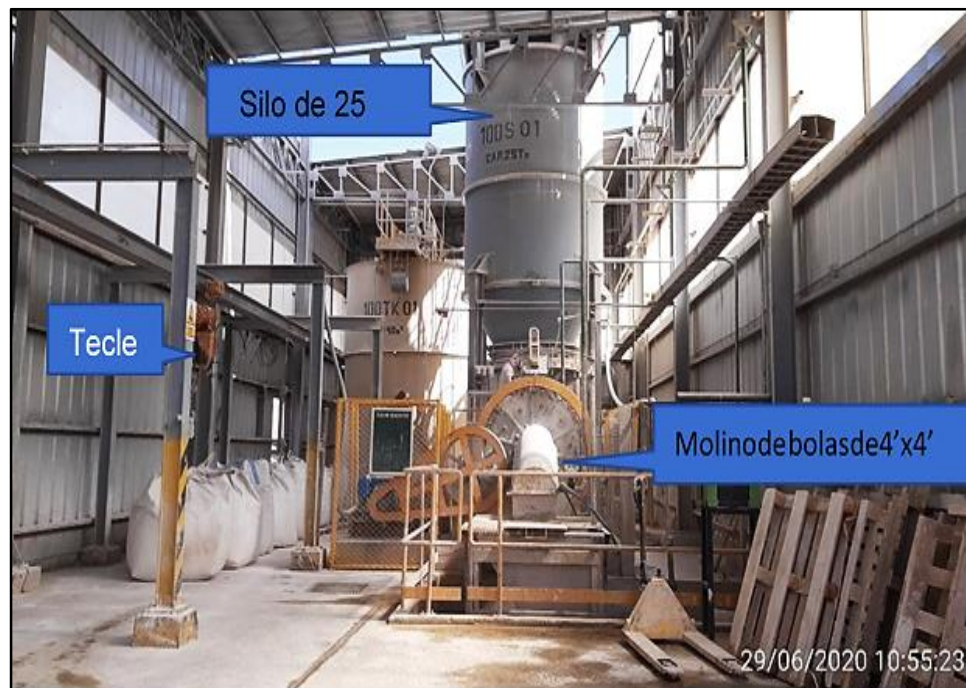
Figura N° 11: Silo de almacenamiento y molienda de la cal hidratada.
