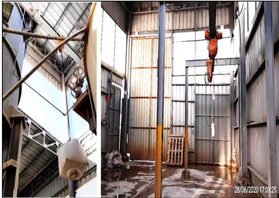
Figura N° 10: Tecles para traslado e izaje de cal hidratada en el recinto de la zona 100.
