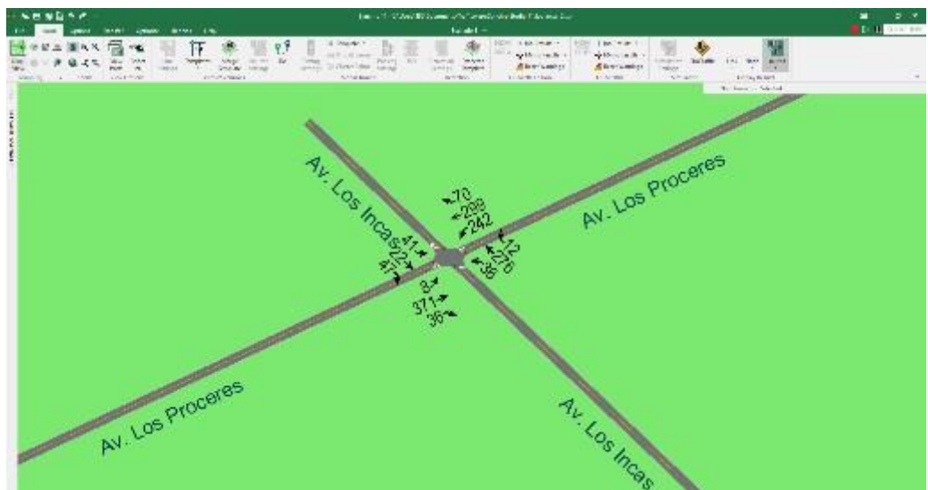
Figura 66. Intersección Av. Los Incas y Av. Los Proceres – Volumen vehicular en Synchro 11.
