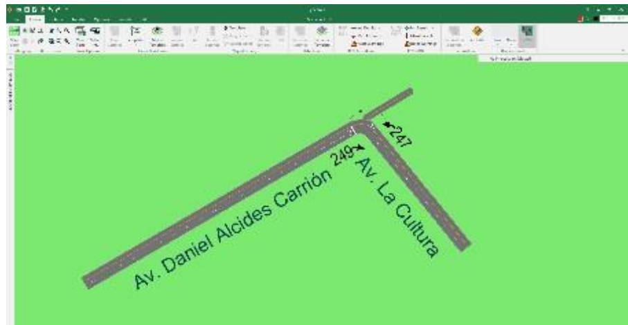
Figura 56. Intersección Av. La Cultura y Av. Daniel Alcides Carrión – Volumen Vehicular en Synchro 11.
