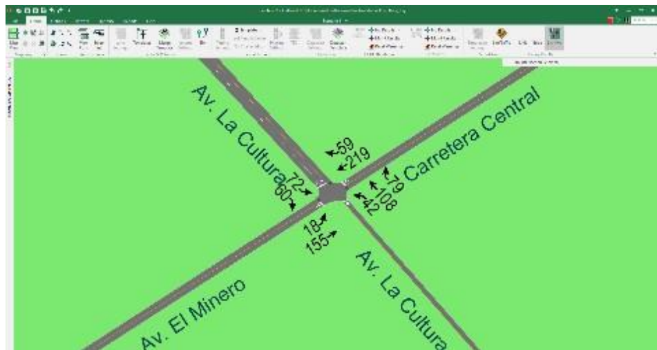
Figura 46. Intersección Av. La Cultura, Av. El Minero y Av. Daniel Alcides Carrión – Volumen Vehicular en Synchro 11
