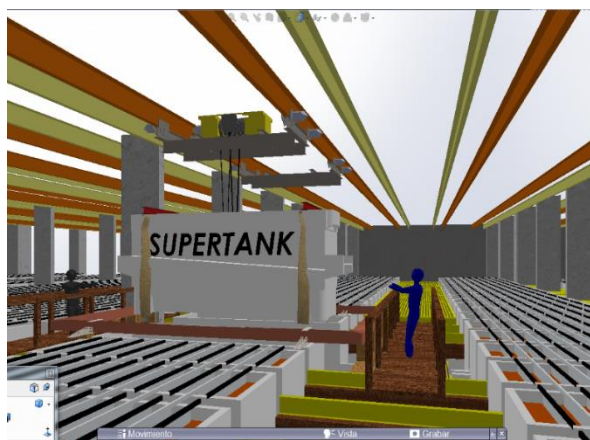
Figura 30: Descenso de la grúa para el retiro de la celda electrolítica
