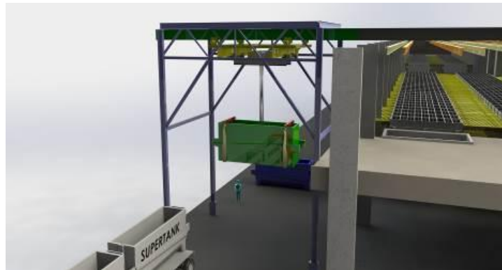
Figura 32: Retiro de la celda descartada
