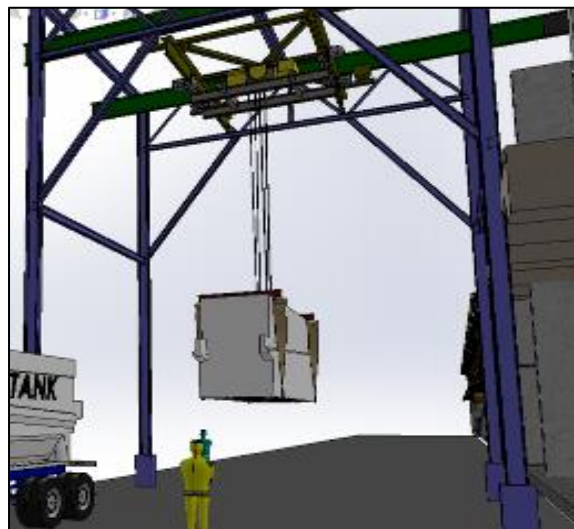
Figura 33: Posición de la celda descartada en el piso
