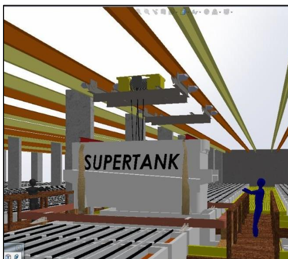
Figura 29: Traslado de la celda electrolítica por la grúa puente
