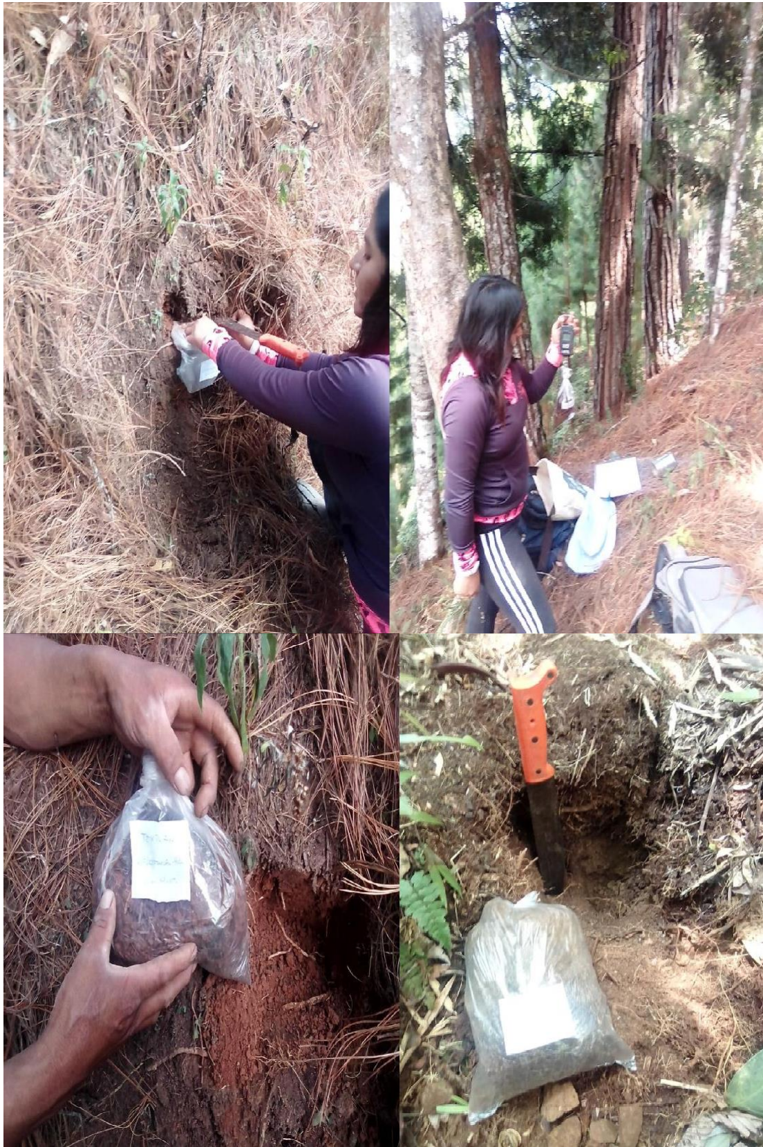
Figura 12: Toma de muestras para el análisis de densidad aparente y textura del suelo.
