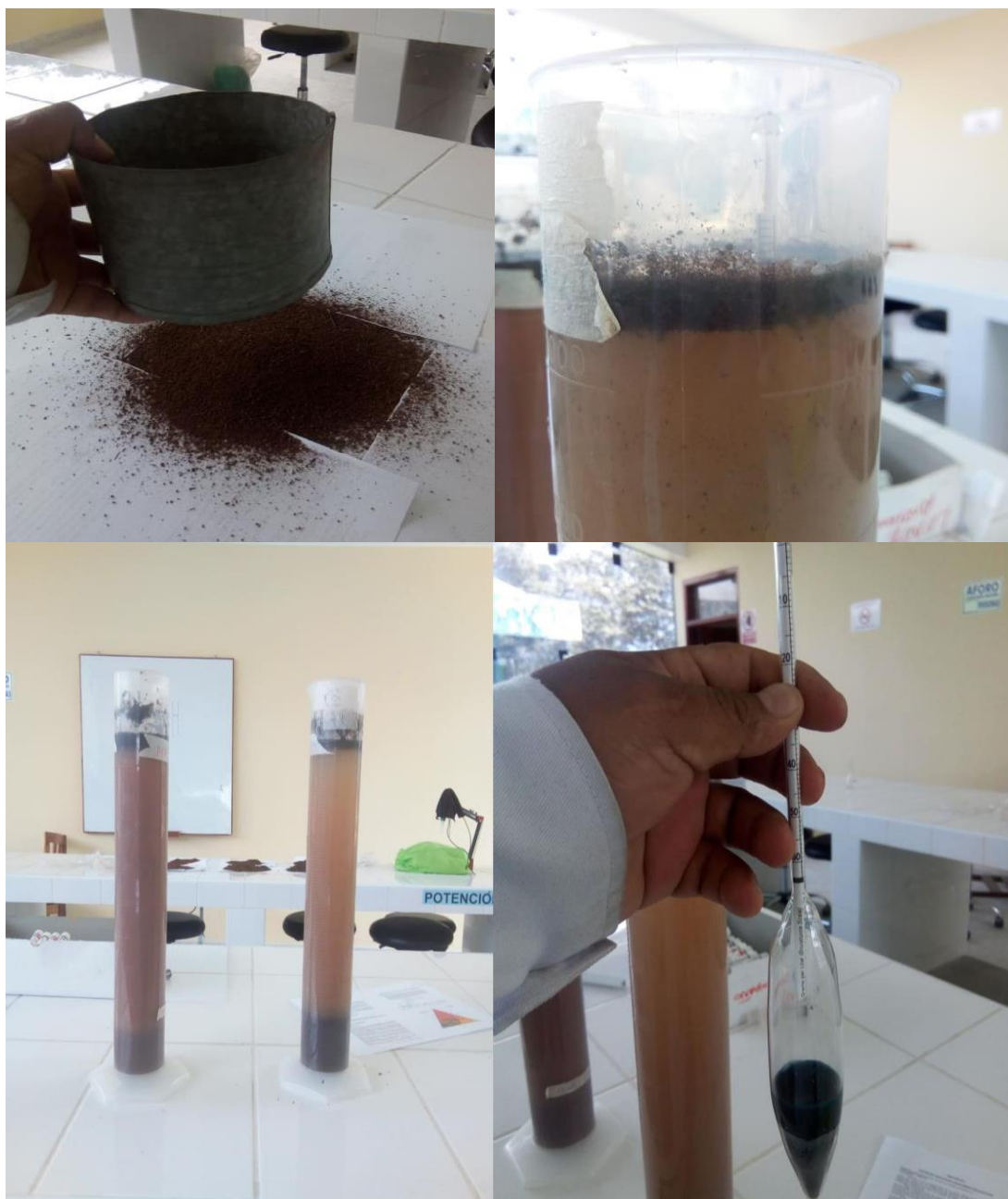
Figura 13: Análisis de textura y densidad aparente en el laboratorio de la Universidad Nacional Daniel Alcides Carrión.
