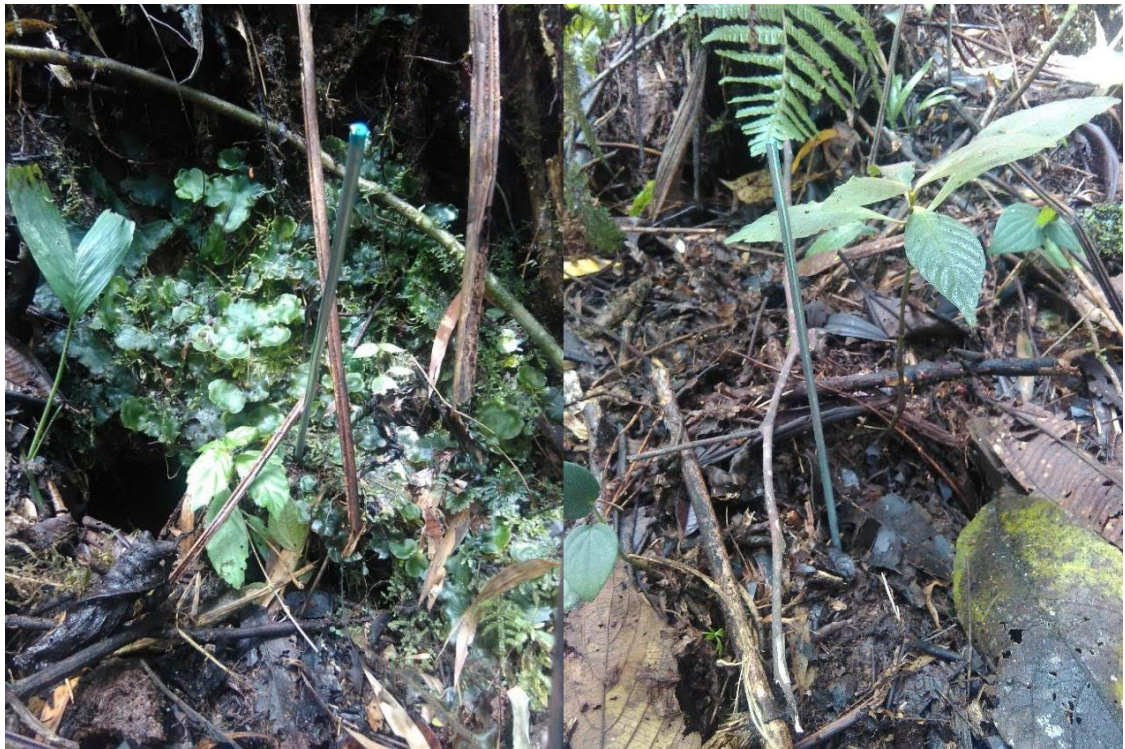
Figura 11: Medición y registro del suelo erosionado y sedimentado del Bosque de montaña montano (Bm-mo) y del área de Cobertura forestal - herbazal.
