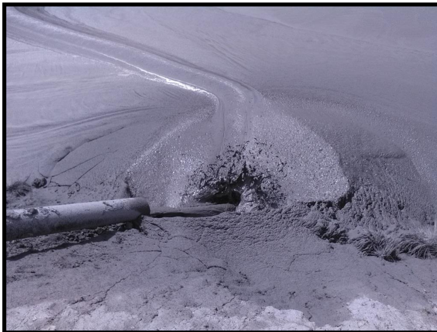
Foto 12. Descarga de relave en pasta al depósito de relave Rumichaca
