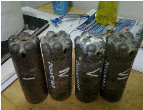
Figura N° 20 Vista de las fallas de los accesorios de perforación.
