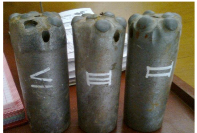
Figura N° 20 Vista de las fallas de los accesorios de perforación.
