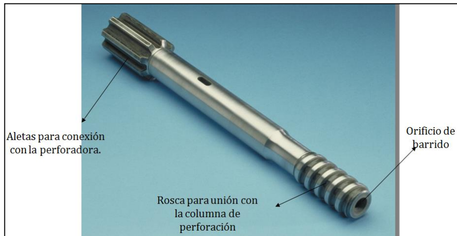
Figura N° 11 Partes de un adaptador de culata
