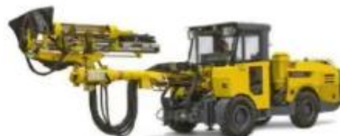
FIGURA 34. Simbas S7D, 20m, Ø: 51-89 mm
